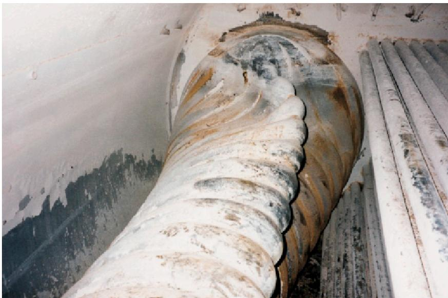
**Fig. 90** Formation de couches dans la chaudière avec endommagement du tube de flamme
