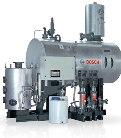
**Fig. 97** Un module de service d'eau, composé d'un réservoir d'eau d'alimentation avec dégazeur à ruissellement, de modules de pompes d'alimentation, d'un vase d'expansion de purge, de réservoirs de dosage et d'une armoire de commande correspondante
