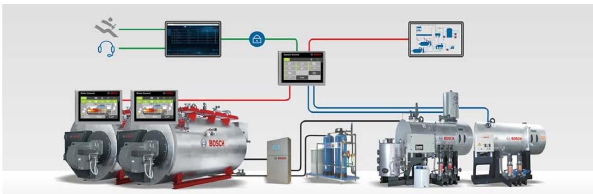
**Fig. 225** Représentation simplifiée du flux de données dans un système avec différents contrôles et MEC Remote
