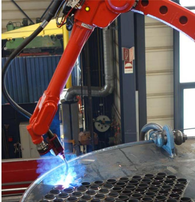
**Fig. 132** Robot de soudage mobile utilisé dans la production de chaudières industrielles Bosch
