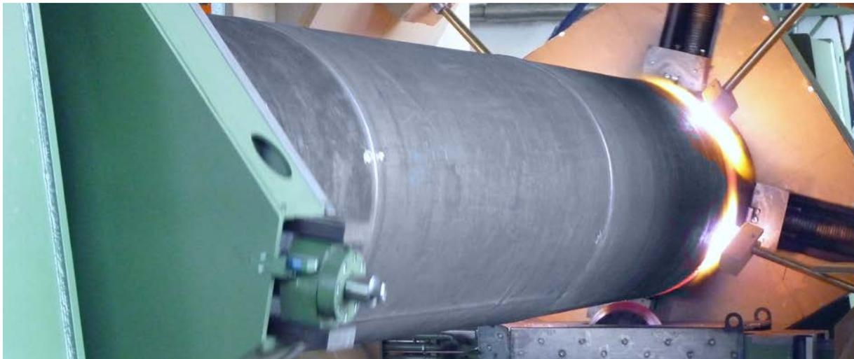
**Fig. 131** La machine à tubes de flamme ondulée entièrement automatique conçue en interne
