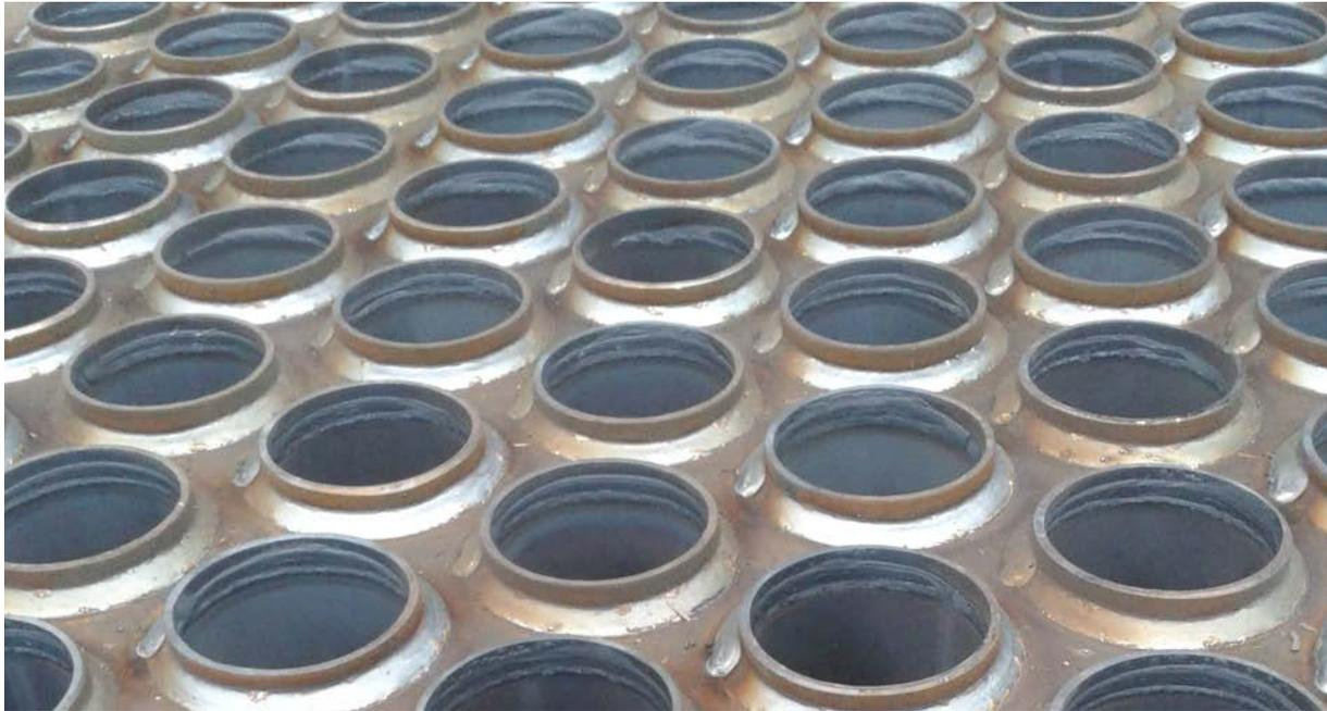
**Fig. 129** Soudure au niveau des tubes de fumée insérés
