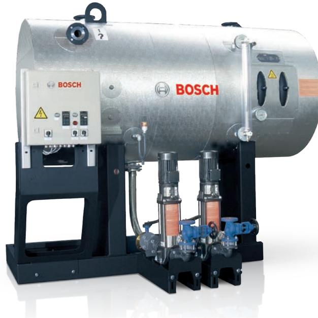
**Fig. 201** *Le module de service des condensats non pressurisé co-traite les flux de condensats et les renvoie dans le circuit eau/vapeur via le système de désaération.*
