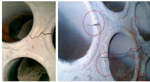
**Fig. 24** Côté fumées avec des fissures dans les côtes de la plaque tubulaire de la chambre d'inversion
