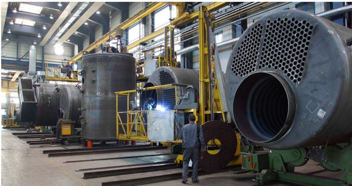
**Fig. 130** Armatures chaudière horizontales et verticales à la production à Gunzenhausen, Allemagne
