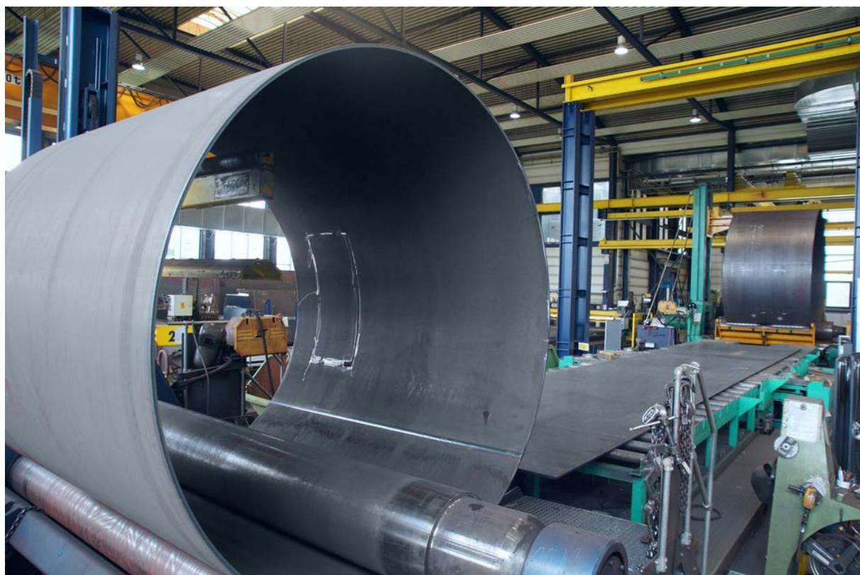
**Fig. 133** *Le pliage de tôles avec des largeurs jusqu'à 3,5 m est possible*
