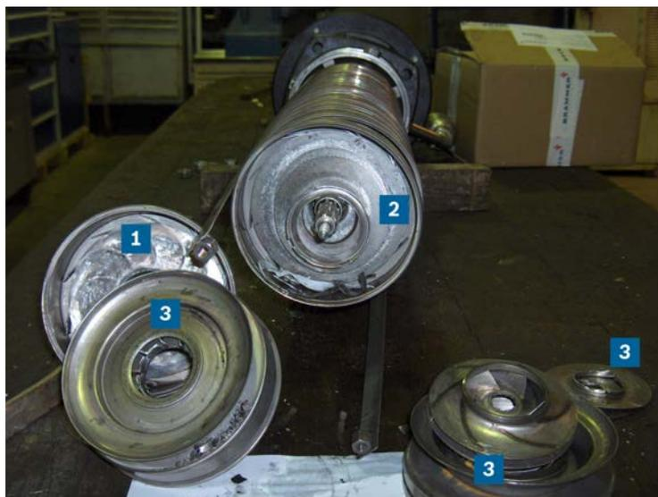
Fig. 26 Dommages de la pompe dus à la cavitation
