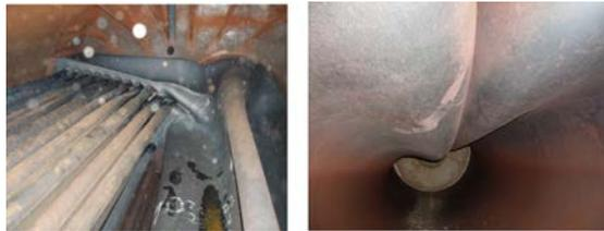
**Fig. 33** Déformation due à une surchauffe résultant d'un manque d'eau
