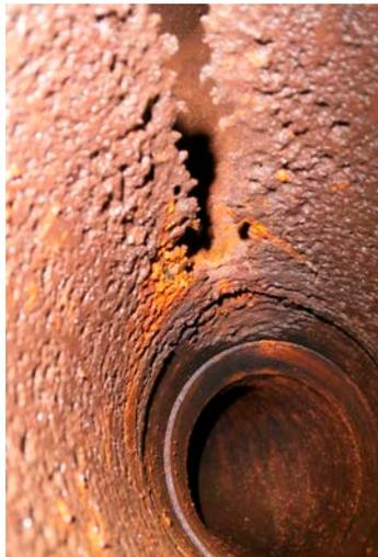
**Fig. 15** Introduction d'eaux résiduelles à des températures supérieures à 100 °C dans le réservoir de purge inférieur, sous la ligne d'eau (au niveau du connecteur pour < 100 °C)
