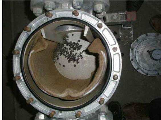
**Fig. 31** Billes de soudure et film de rouille dans le filtre à gaz
