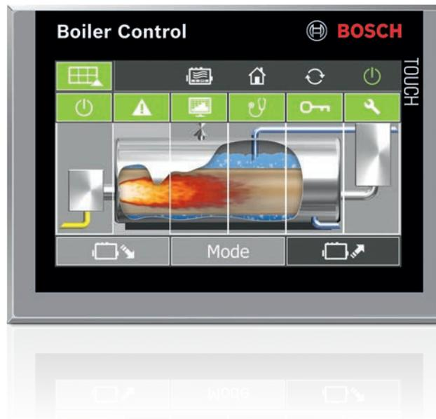
**Fig. 220** Écran d'accueil de la commande de chaudière BCO pour les systèmes de chaudière à vapeur
