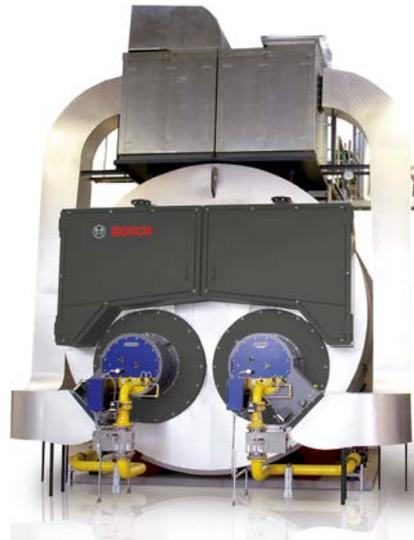
**Fig. 49** Brûleur duobloc avec ventilateur sur la couronne de la chaudière et conduits d'air de combustion (Saacke)
