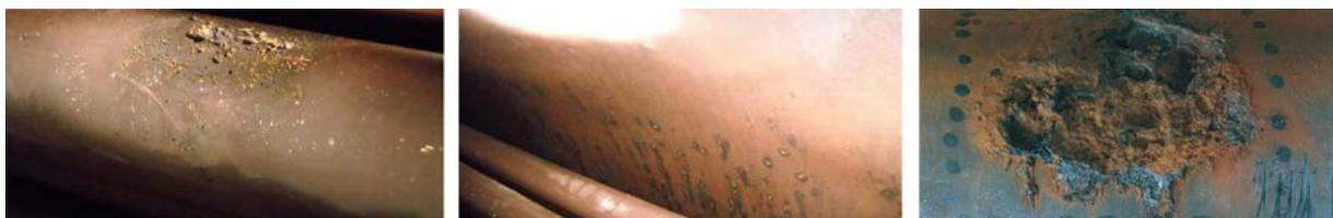
**Fig. 95** Dommages dus à l'oxydation dans la chaudière et sur la tuyauterie
