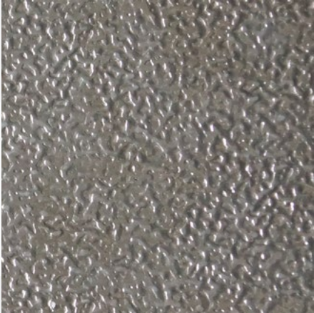
Abbildung 6: Außenverkleidung Aluminium Blech
