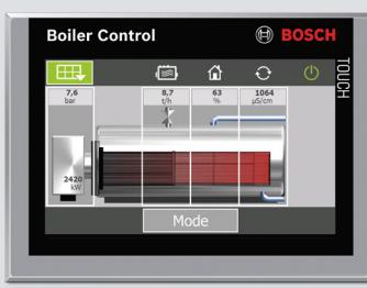
Mit der **Kesselsteuerung BCO** können Sie den ELSB einfach über ein Touchdisplay bedienen. Die **Systemsteuerung SCO** bietet zudem die Möglichkeit, Mehrkesselanlagen zu integrieren. Beide Bosch-Steuerungen sind mit allen gängigen Leittechniksystemen kompatibel und verfügen optional über einen geschützten Fernzugriff.
