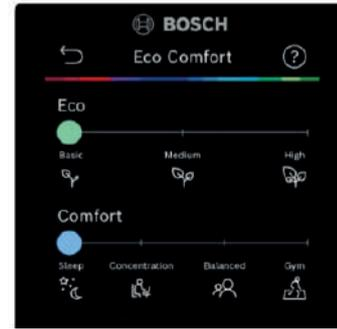
EL ARC Touch integra un completo algoritmo de funcionamiento basado en las preferencias del cliente. De forma muy intuitiva, el usuario final sólo tendrá que definir los niveles de ahorro y de confort esperados en función de su actividad, para que el control decida el funcionamiento más adecuado del sistema.
