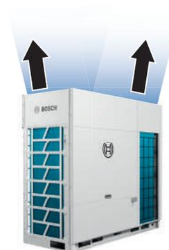
La función de limpieza de nieve automático protege la unidad exterior de la nieve - Los ventiladores funcionan automáticamente durante un corto período de tiempo para quitar la nieve. Esta configuración se controla a través del interruptor DIP en la PCB de la unidad exterior.
