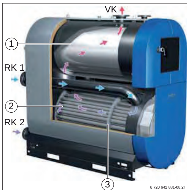
Gráfico 9 Diagrama de funcionamiento del recorrido del agua en la caldera de condensación de pie Logano plus SB745
