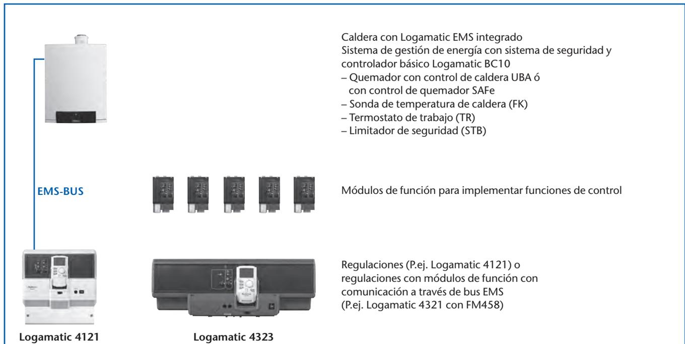
5/1 Regulaciones Logamatic 4000 para calderas y quemadores con control digital de la combustión
