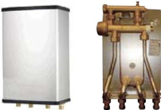
El sistema de intercambio, consta de una válvula proporcional que consigue un alto rendimiento del intercambiador, ya que cuando hay consumo la válvula se abre y adapta el grado de apertura al caudal de circulación. En el caso de no haber consumo, la válvula cierra el paso al intercambiador.
