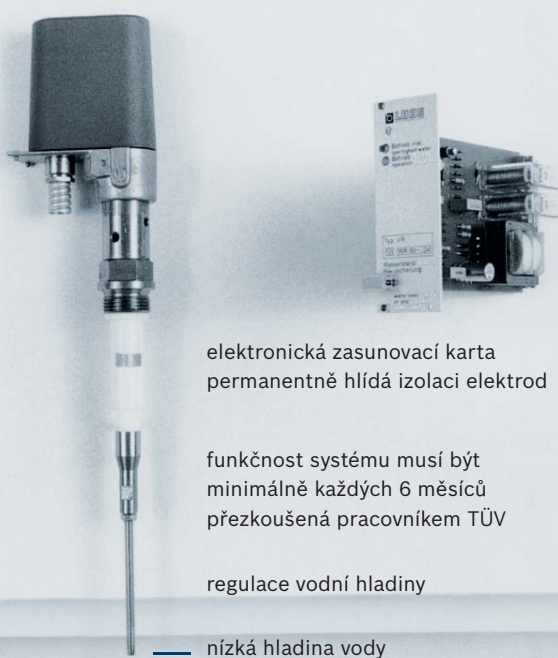
Obrázek 3: Dvoukanálové řízení hladiny vody pomocí elektrod – toto zařízení musí být minimálně každých 6 měsíců přezkoušeno organizací TÜV
