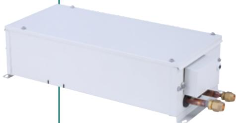
**Fonction principale :** En cas de fuite de fluide R32, le kit rapatrie le R32 à l'extérieur des pièces vers le groupe puis ferme ses vannes afin de limiter la fuite. À utiliser en complément d'un système de détection de fuite.
