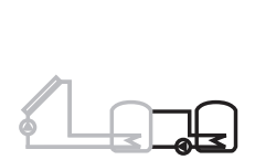
Travaso bollitori con scambiatore
