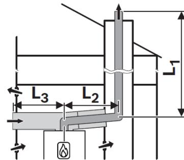
Lunghezze massime ammesse [m] per sistema fumario sdoppiato tipo **C53<sub>x</sub>**, con scarico fumi a parete o su tetto, PP **flessibile**
