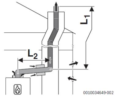
Lunghezze massime ammesse [m] per sistema fumario sdoppiato tipo **B53<sub>p</sub>**, con scarico fumi a parete o su tetto, PP **flexibile**
