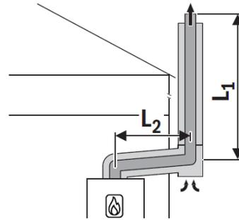
Lunghezze massime ammesse [m] per sistema fumario sdoppiato tipo **C53**, con scarico fumi a parete o su tetto, PP **rigido**
