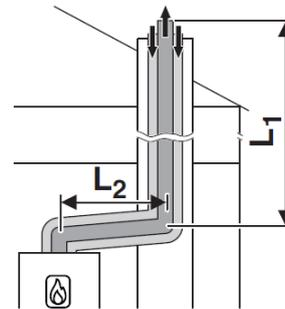
Lunghezze massime ammesse [m] per sistema fumario concentrico verticale tipo **C33<sub>x</sub>**, attraverso tetto piano o inclinato, PP **rigido**
