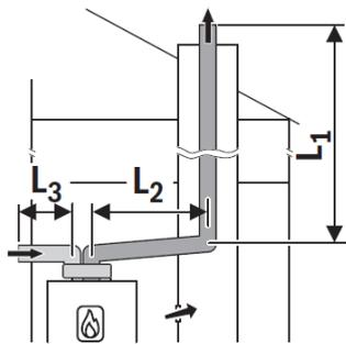
Lunghezze massime ammesse [m] per sistema fumario sdoppiato tipo **B53<sub>p</sub>**, con scarico fumi a parete o su tetto, PP **rigido**
