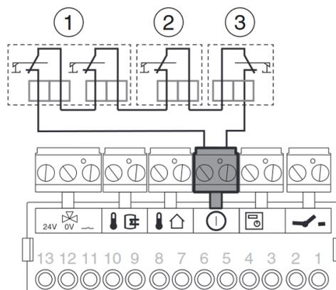
*Esempio collegamento della serie delle sicurezze INAIL su singola caldaia*
