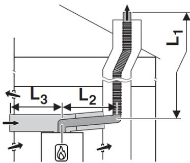
Lunghezze massime ammesse [m] per sistema fumario verticale tipo **C53<sub>x</sub>**, con scarico fumi sulla parete esterna, PP **rigido**
