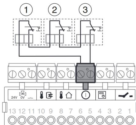
*Esempio collegamento della serie delle sicurezze INAIL su singola caldaia*
