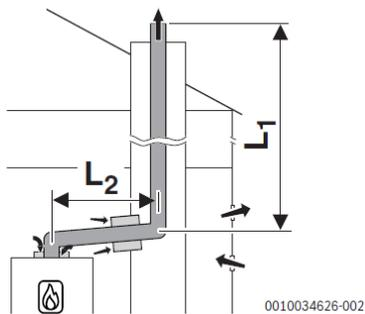
Lunghezze massime ammesse [m] per sistema fumario sdoppiato tipo **B53<sub>p</sub>**, con scarico fumi a parete o su tetto, PP **flessibile**
