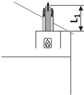
Lunghezze massime ammesse [m] per sistema fumario sdoppiato tipo **C53<sub>x</sub>**, con scarico fumi a parete o su tetto, PP **rigido**
