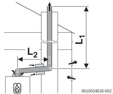
Lunghezze massime ammesse [m] per sistema fumario sdoppiato tipo **B53<sub>p</sub>**, con scarico fumi a parete o su tetto, PP **rigido**
