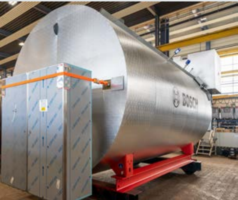
Fig. 2: Caldera híbrida en la fábrica de Bosch poco antes de ser enviada a España. El haz de calefacción eléctrica utiliza más de 5 MW de electricidad verde procedente de la propia instalación fotovoltaica del cliente. El quemador cubre entonces de forma fiable las necesidades adicionales. Dado que la planta va a utilizar electrólisis in situ, el sistema de caldera ya ha sido diseñado para funcionar con hasta un 100% de hidrógeno.
