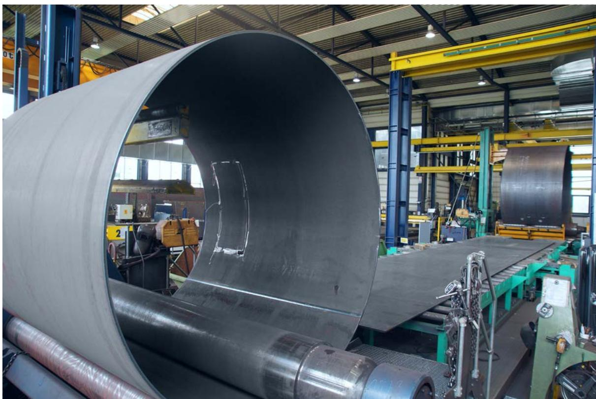
**Fig. 133** Posibilidad de plegar láminas metálicas de hasta 3.5 m de ancho
