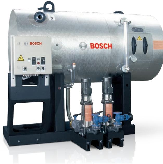
**Fig. 200** El módulo de servicio de condensado no presurizado recoge los flujos de condensado y los canaliza de vuelta al circuito de agua/vapor a través del sistema de desaireación
