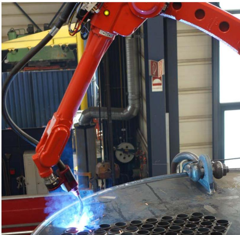
**Fig. 132** Robot de soldadura móvil utilizado en la producción de calderas industriales de Bosch
