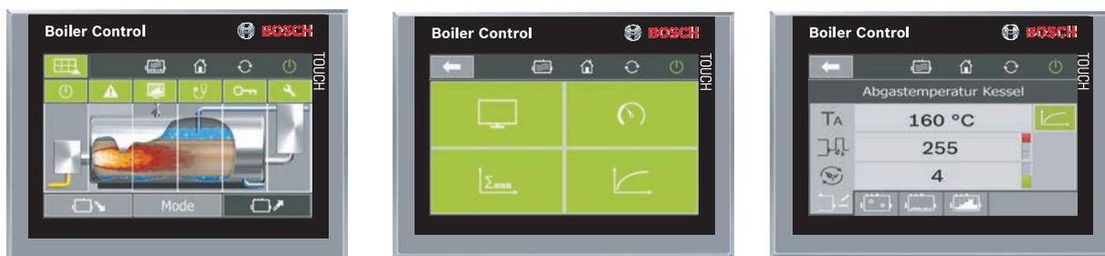
**Fig. 83** Ejemplos de guía del usuario en el control de la caldera BCO
