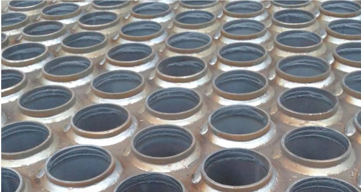
**Fig. 129** Soldadura de costuras en tubos de humo insertados
