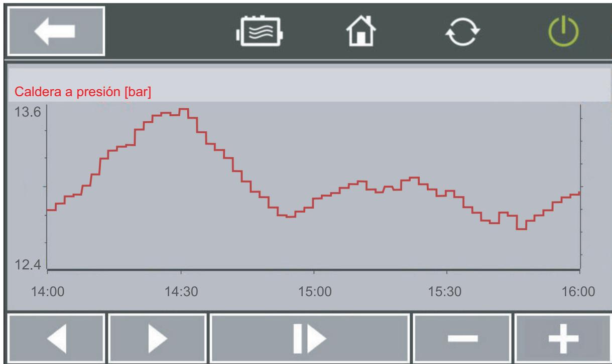
**Fig. 5** Ilustración de la curva de presión a lo largo del tiempo (control de caldera BCO)
