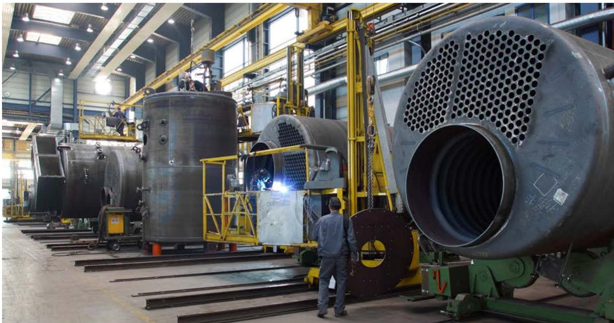
**Fig. 130** Calderas horizontales y verticales en la fábrica de Gunzenhausen (Alemania)
