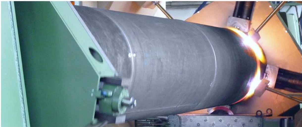
**Fig. 131** La máquina de tubos ondulados de llama totalmente automática de diseño propio
