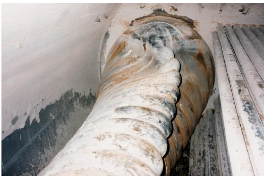
**Fig. 90** Formación de capas en caldera con daños en el tubo de llama
