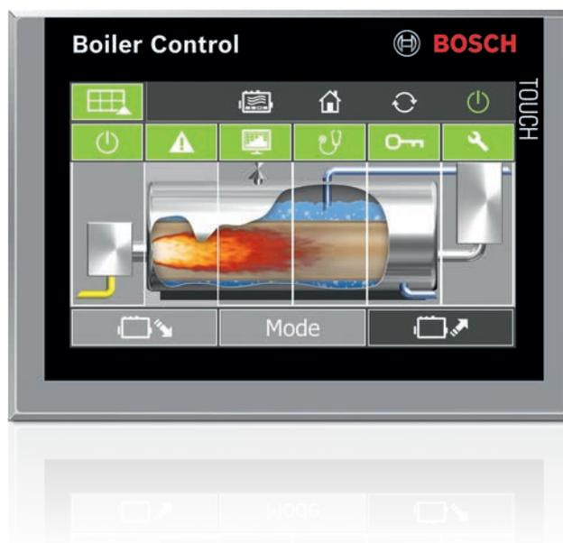
**Fig. 221** Pantalla de inicio del control de calderas BCO para sistemas de calderas de vapor
