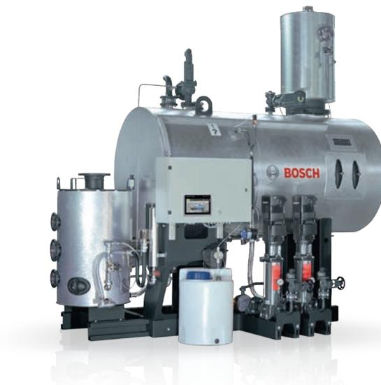
**Fig. 97** Un módulo de servicio de agua, compuesto por un depósito de agua de alimentación con desgasificador por goteo, módulos de bomba de alimentación, vaso de expansión de purga, depósitos dosificadores y el armario de control correspondiente.
