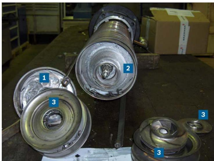
**Fig. 26** Daños en la bomba por cavitación
