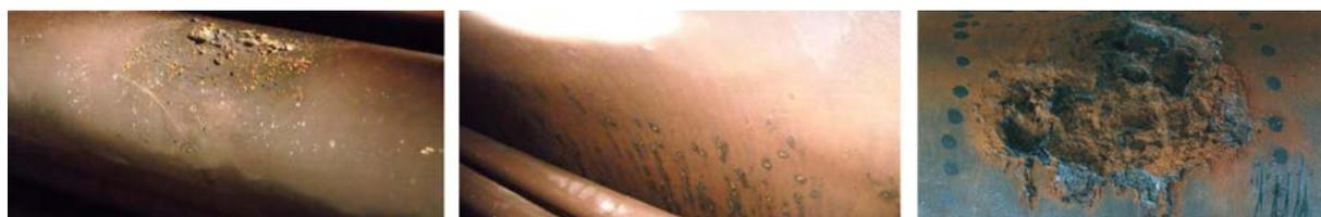
**Fig. 95** Daños por oxidación en la caldera y en las tuberías
