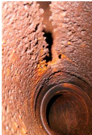
**Fig. 15** Introducción de aguas residuales a temperaturas superiores a 100 °C en el depósito de purga inferior por debajo de la línea de agua (en el conector para <100 °C)
