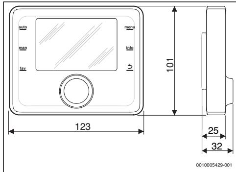
Рис. 2 Размеры, мм
