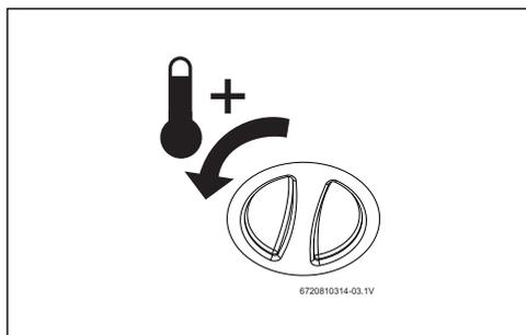
Fig. 12 Augmentation de la température
