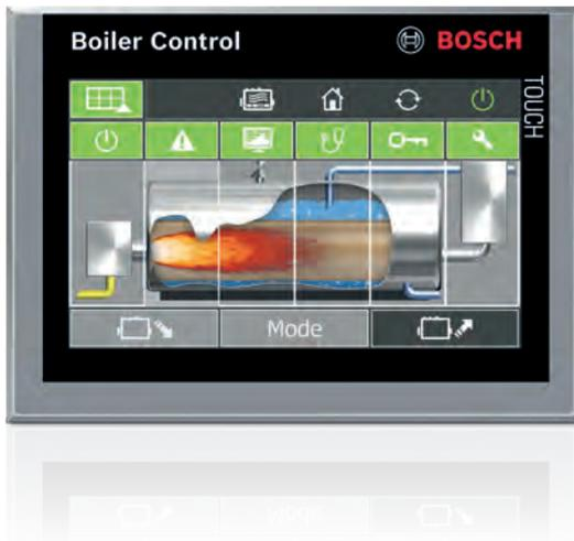
El sistema de control de caldera BCO ofrece todas las funciones esenciales para poder llevar a cabo la operación segura de calderas de vapor y agua sobrecalentada de acuerdo a los más exigentes requerimientos del cliente.
