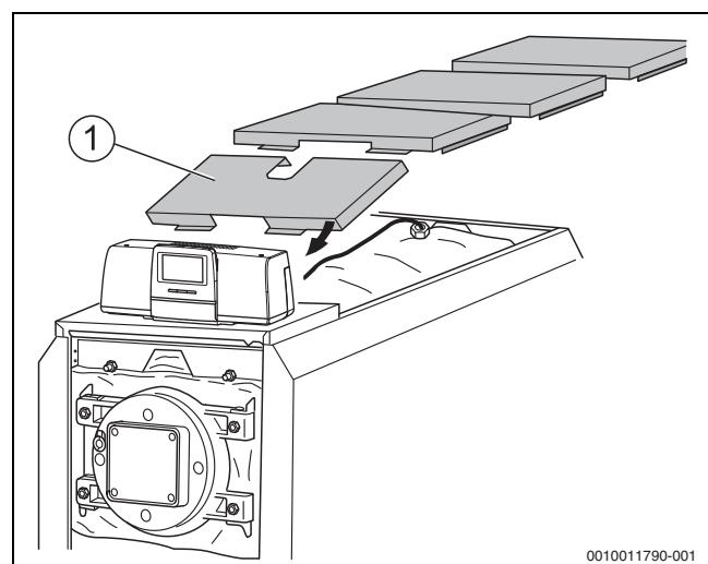
Sl.22 Stavljanje dijelova poklopca - shematski prikaz
