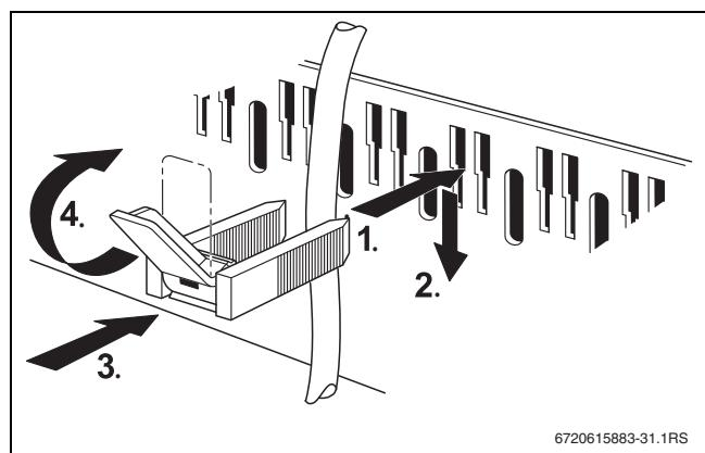
Sl.34 Kabel osigurati kabelskom obujmicom
