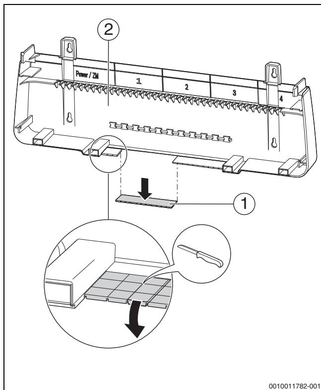
Sl.39 Priprema kabelske uvodnice
