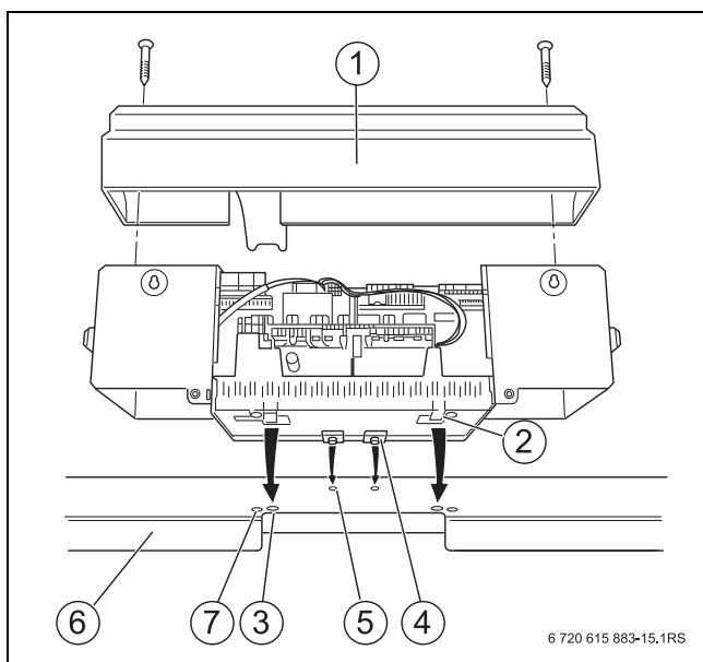
Sl.32 Montaža regulacijskog uređaja
