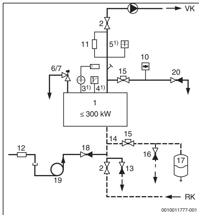
Sl.49 Sigurnosno-tehnička oprema prema EN 12828:2012 za kotao  $\leq 300 \text{ kW}$  sa sigurnosnim graničnikom temperature (STB)  $\leq 110^\circ\text{C}$
