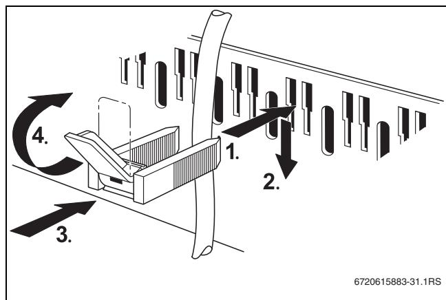
Sl. 37 Kabel osigurati kabelskom obujmicom
