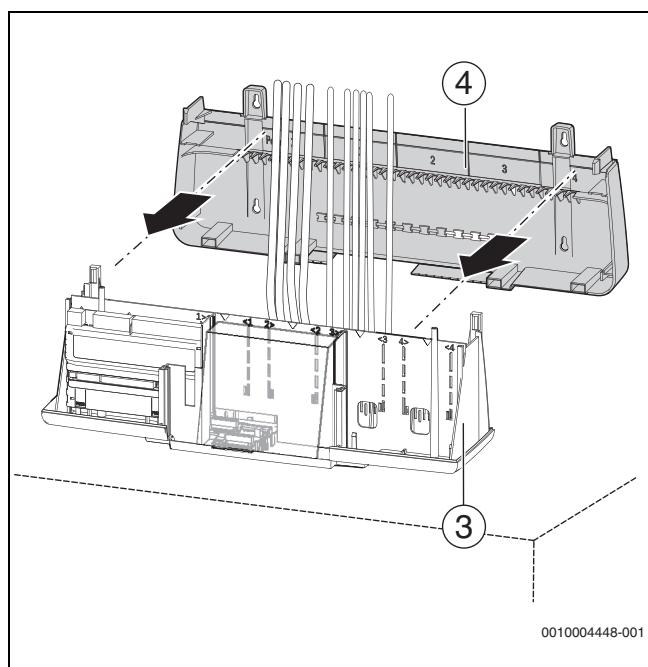
Sl. 38 Montaža na kotlu, postavljanje i ugavljinjanje stražnje stijenke
