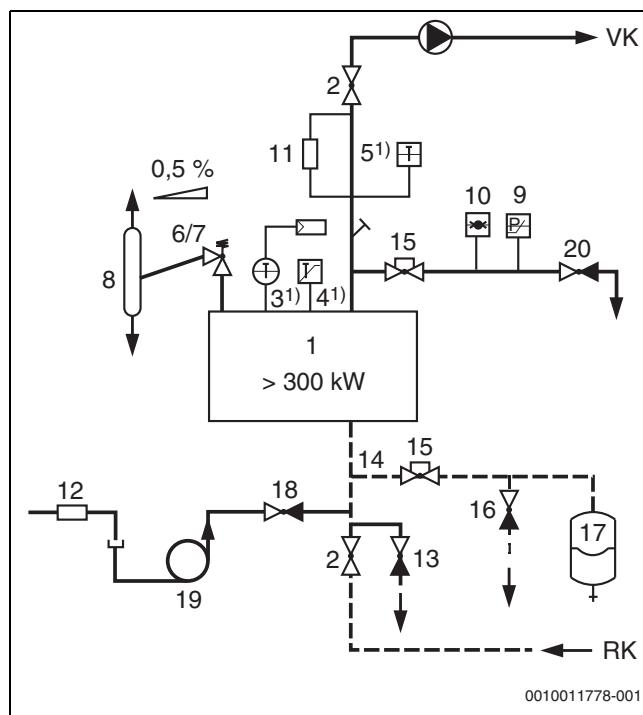
Sl.50 Sigurnosno-tehnička oprema prema EN 12828:2012 za kotao  $> 300 \text{ kW}$  sa sigurnosnim graničnikom temperature (STB)  $\leq 110^\circ\text{C}$
