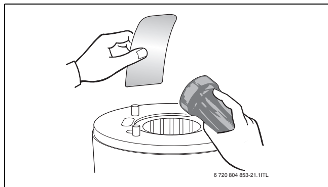
Мал. 63 Перевірка котлового блока, який включає камеру згорання і теплообмінник, на наявність відкладень
