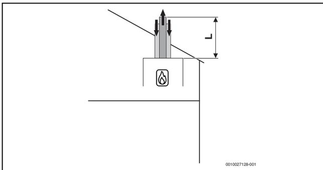
Bild 13 Vertikale konzentrische Luft-Abgas-Führung nach C<sub>33x</sub>
