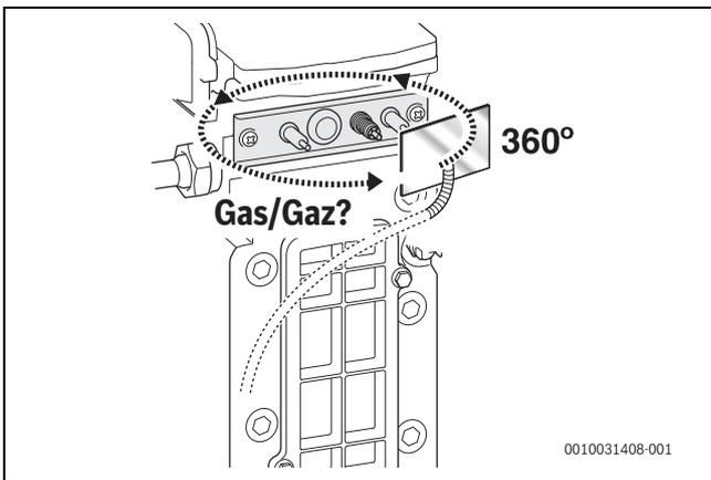
Bild 57 Dichtheit kontrollieren
