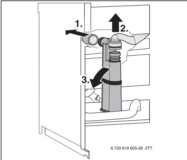
Bild 64 Kondensatsiphon ausbauen
