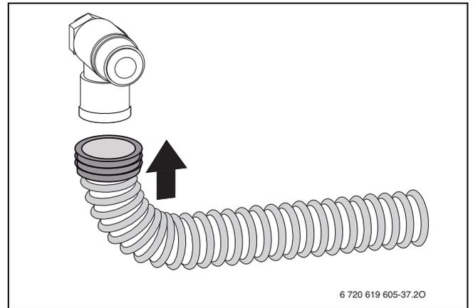
Bild 30 Schlauch am Sicherheitsventil montieren
