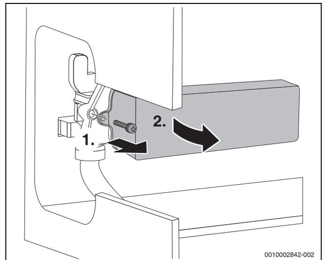
Bild 67 Plattenwärmetauscher ausbauen
