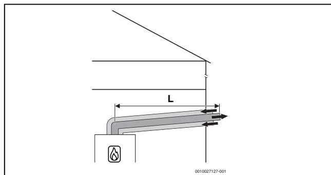
Bild 11 Horizontale konzentrische Luft-Abgas-Führung nach C<sub>13x</sub> durch die Außenwand
