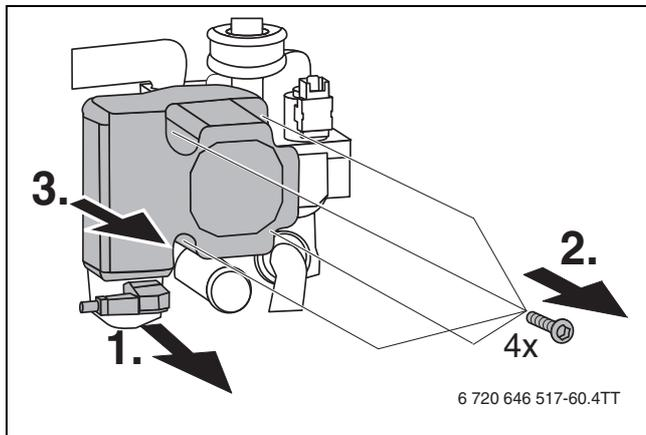
Bild 77 Heizungspumpe ausbauen
