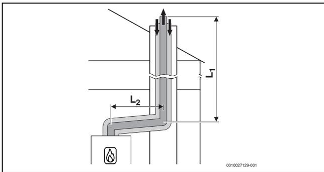
Bild 12 Konzentrische Luft-Abgas-Führung nach C<sub>33x</sub> im Schacht
