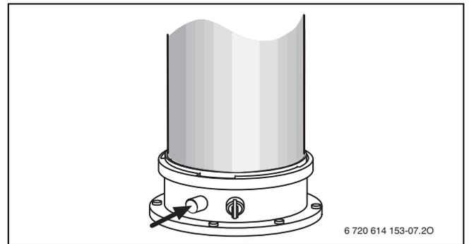
Bild 51 Abgasmessstutzen
