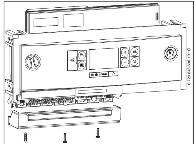
Bild 35 Abdeckung entfernen
