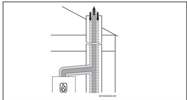
Bild 14 Konzentrische Luft-Abgas-Führung nach C<sub>(10)3x</sub> im Aufstellraum
