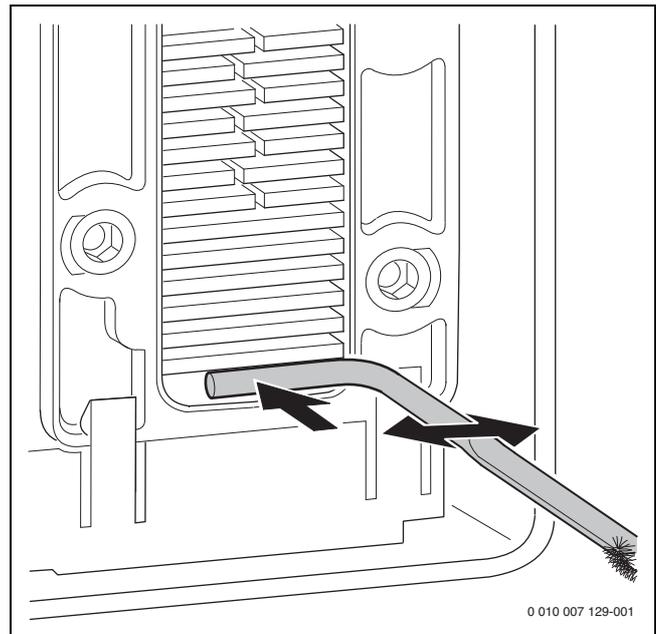
Bild 63 Kondensatwanne reinigen
