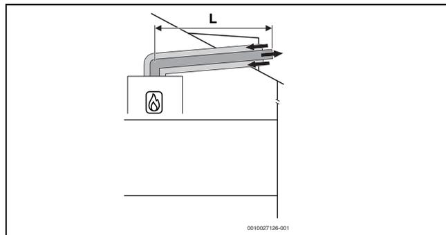
Bild 10 Horizontale konzentrische Luft-Abgas-Führung nach C<sub>13x</sub> über das Dach
