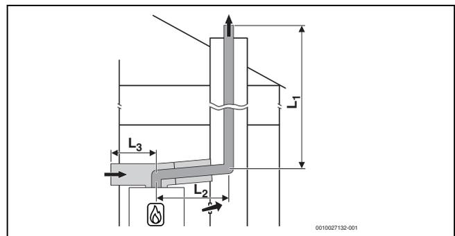
Bild 15 Starre Abgasführung nach C<sub>53x</sub> im Schacht und Luft-Abgas-Führung mit separater Luftzufuhr und konzentrischer Abgasableitung im Aufstellraum
