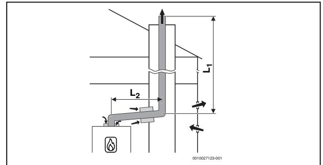
Bild 20 Starre Abgasführung im Schacht nach B<sub>23p</sub>/B<sub>53p</sub> mit raumluftabhängiger Luftzufuhr am Gerät und konzentrischem Verbindungsstück zwischen Aufstellraum und Schacht
