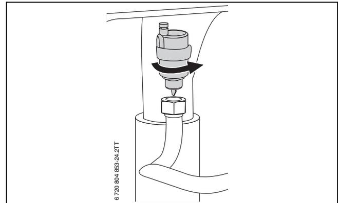
Bild 70 Automatischen Entlüfter ausbauen
