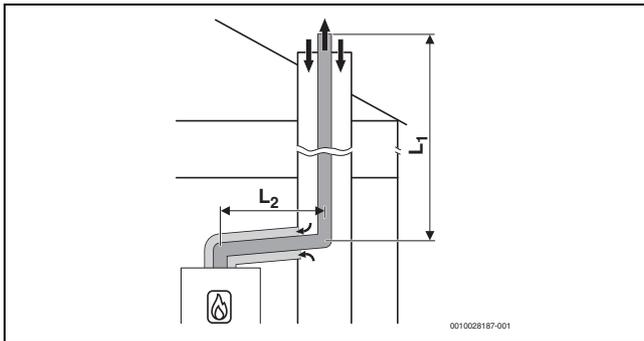
Bild 18 Starre Abgasführung nach C<sub>93x</sub> im Schacht und konzentrische Luft-Abgas-Führung im Aufstellraum
