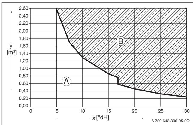
Bild 26 Anforderungen an Füll- und Ergänzungswasser Geräte < 50 kW
