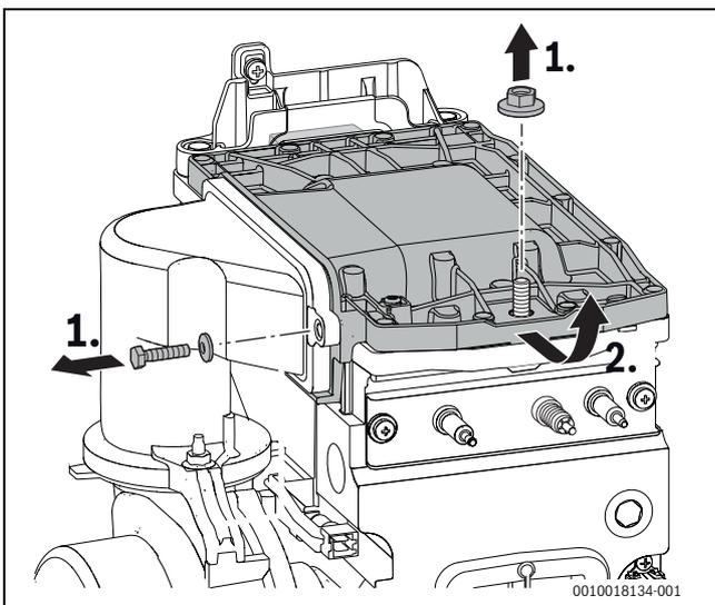
Bild 58 Brennerdeckel lösen
