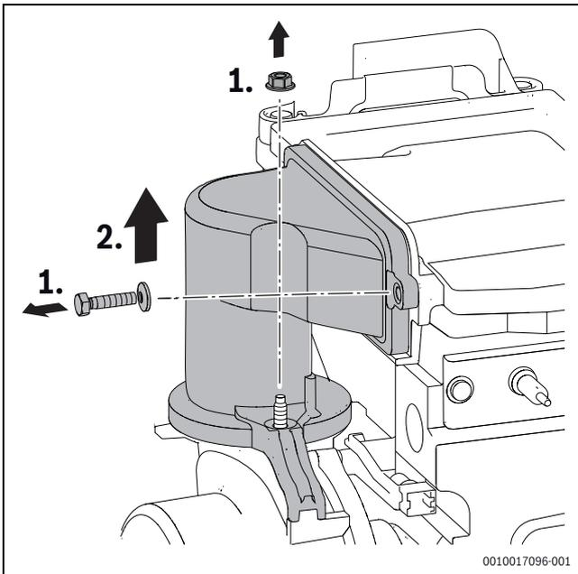
Bild 65 Mischeinrichtung ausbauen
