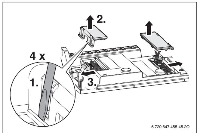
Bild 80 Abdeckung entfernen
