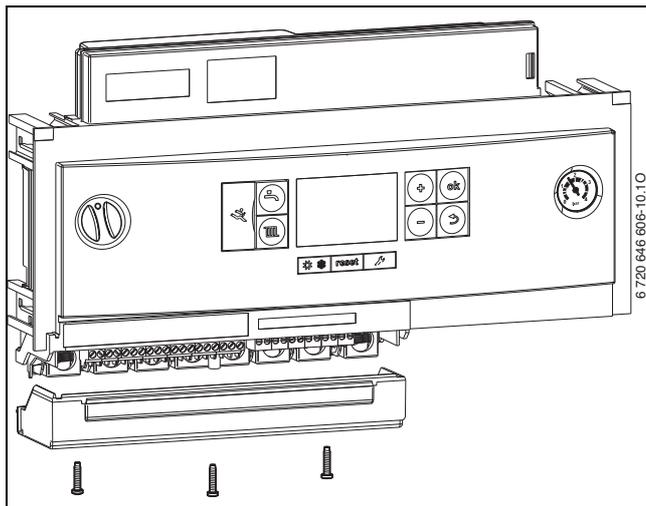
Bild 78 Abdeckung entfernen
