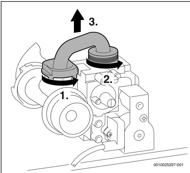
Bild 74 Gasrohr ausbauen
