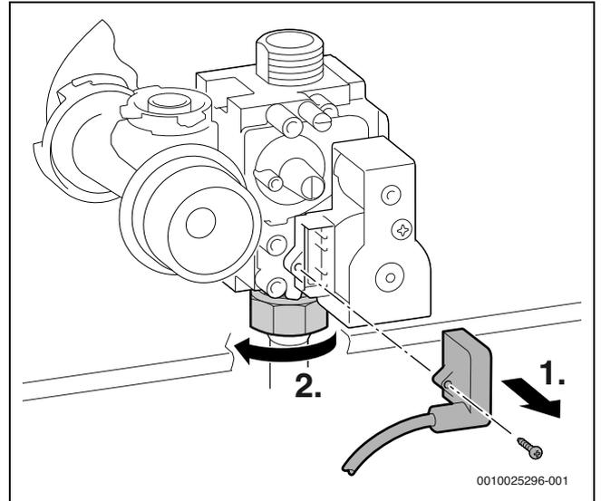
Bild 75 Stecker abziehen und Überwurfmutter lösen
