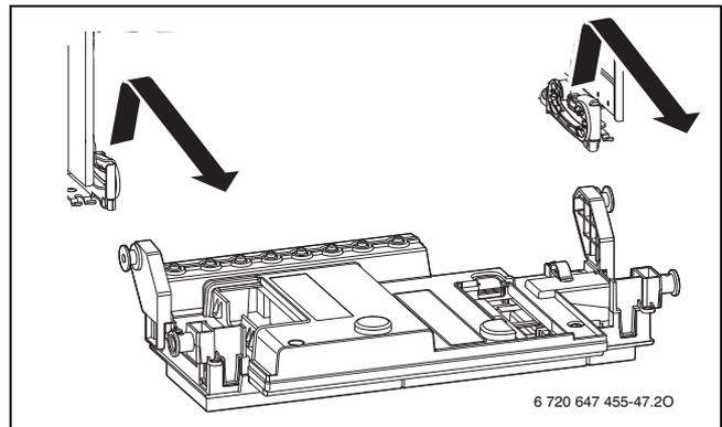
Bild 81 Steuergerät aushängen
