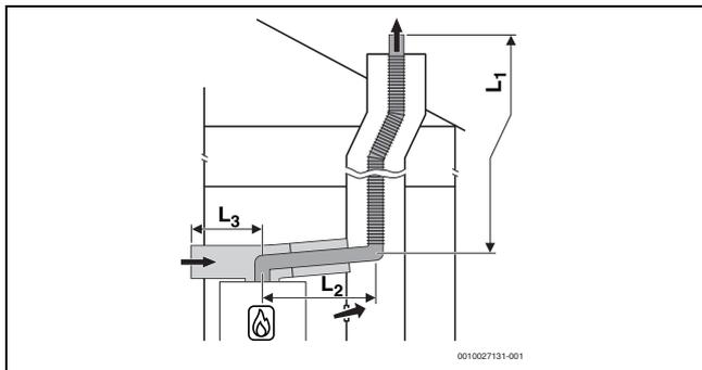
Bild 16 Flexible Abgasführung nach C<sub>53x</sub> im Schacht und Luft-Abgas-Führung mit separater Luftzufuhr und konzentrischer Abgasableitung im Aufstellraum
