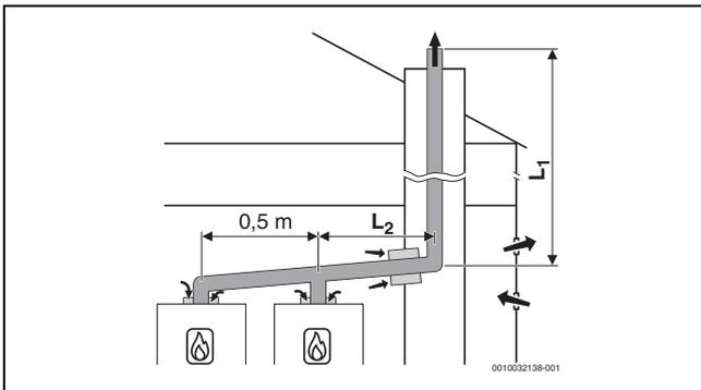
Bild 24 Kaskade mit 2 Geräten:
