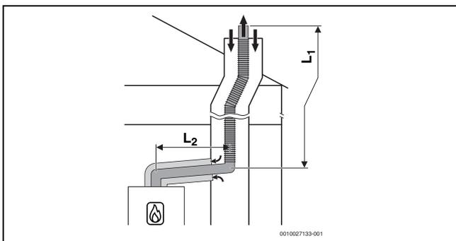
Bild 19 Flexible Abgasführung nach C<sub>93x</sub> im Schacht und konzentrische Luft-Abgas-Führung im Aufstellraum
