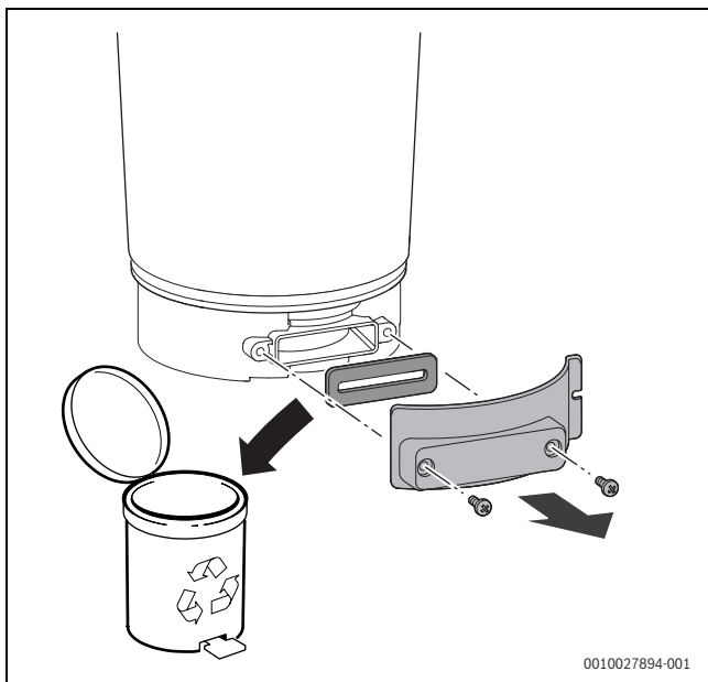
Afb. 123 Open de inspectieopening
