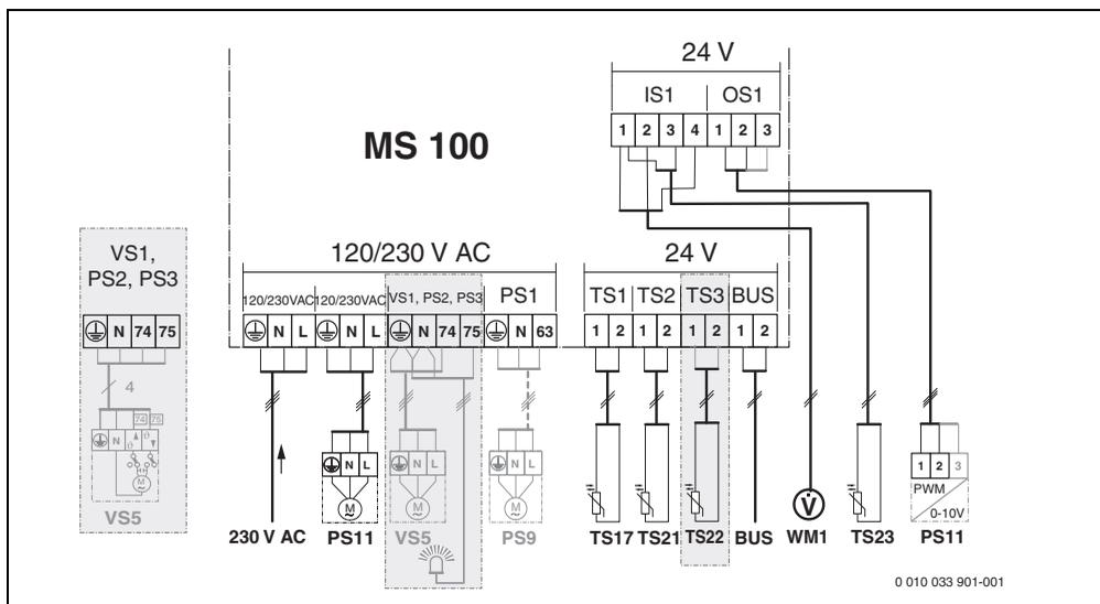
Obr. 2 Obsadenie pripojovacích svoriek pre systém pitnej vody:
