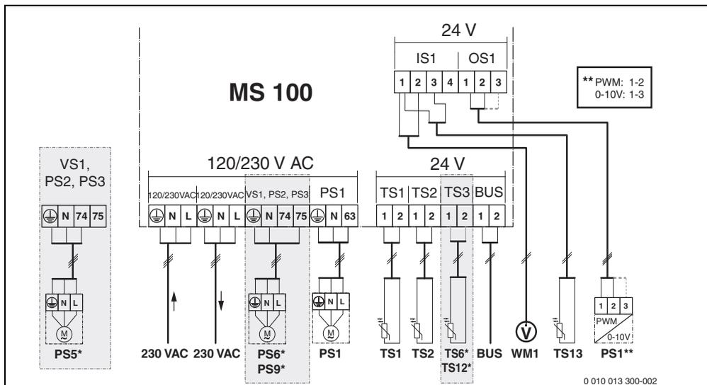
Obr. 1 Osazení přípojovacích svorek pro solární zařízení
