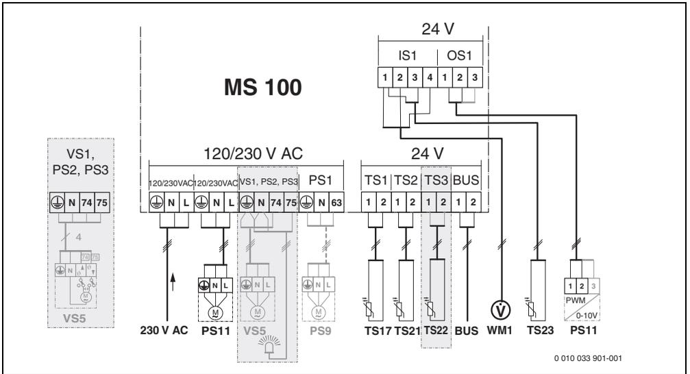
Bild 2 Anslutningsplinttilldelning för färskvattensystem
