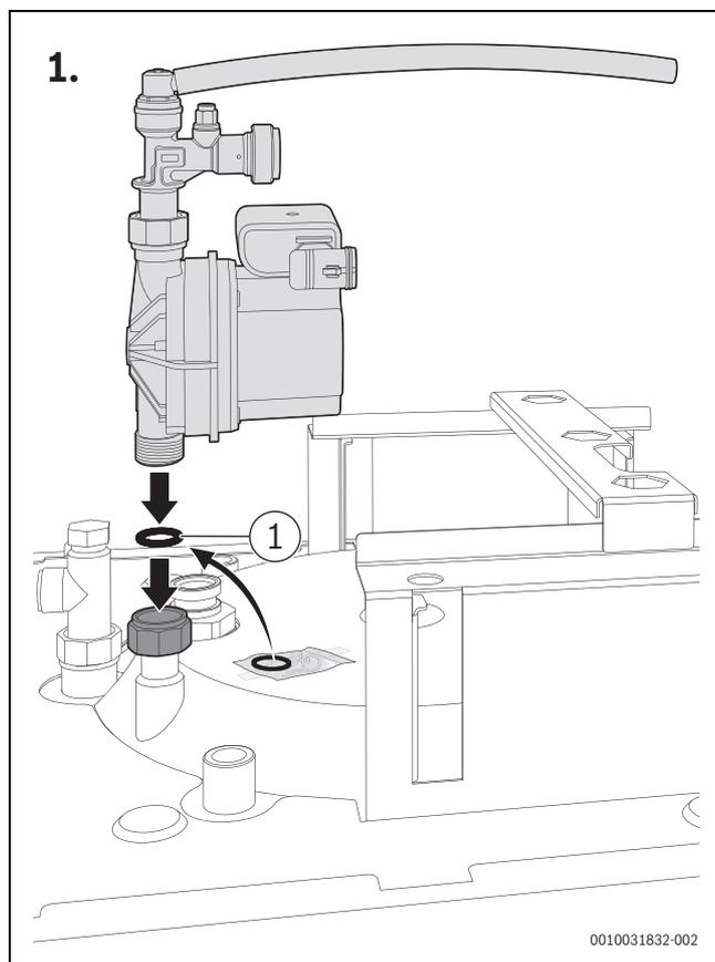
Fig. 43 Introdurre la pompa di carico bollitore
