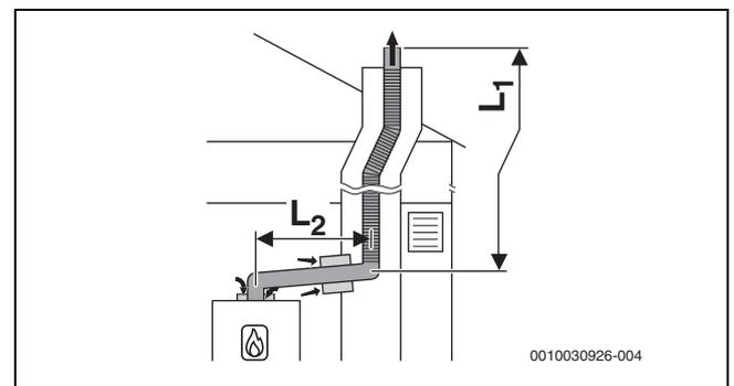
Fig. 30 Sistema fumario flessibile nel cavedio, secondo B<sub>53P</sub> con adduzione aria comburente sull'apparecchio e dipendente dall'aria del locale e con elemento di collegamento concentrico tra luogo di posa e cavedio
