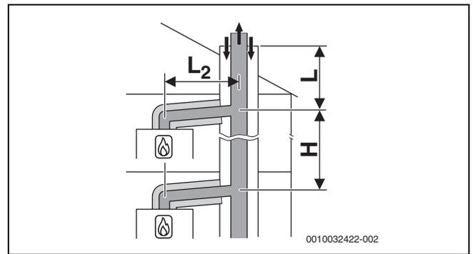
Fig. 33 Collettore scarico gas combusti secondo  $C_{(14)3x}$  con sistema di aspirazione aria comburente/evacuazione prodotti della combustione collettivo concentrico e condotto di aspirazione aria comburente/evacuazione prodotti della combustione concentrico nel luogo di posa
