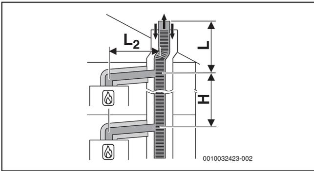
Fig. 34 Collettore scarico combusto secondo  $C_{(14)3x}$  con condotto di evacuazione prodotti della combustione collettivo e condotto di aspirazione aria comburente/evacuazione prodotti della combustione concentrico nel luogo di posa
