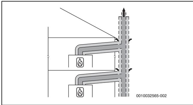
Fig. 32 Collettore scarico gas combusti secondo  $C_{(12)3x}$  con condotto di aspirazione aria comburente/evacuazione prodotti della combustione concentrico nel luogo di posa
