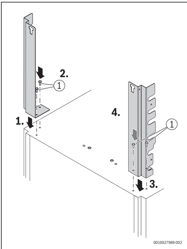
Fig. 45 Installazione di Modulo base (accessorio CS 35) – fase 1
