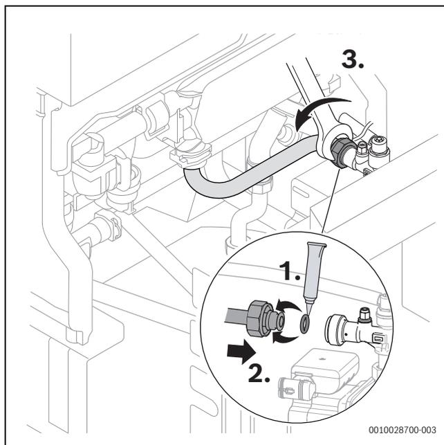
Fig. 60 Collegare il tubo acqua fredda sanitaria del circuito di carico bollitore
