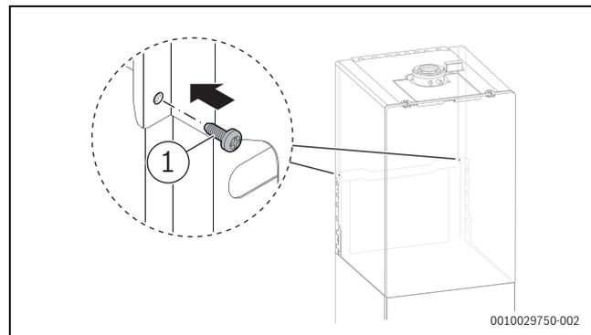
Fig. 89 Fissaggio dei pannelli laterali del mantello sul lato destro e sinistro con le viti
