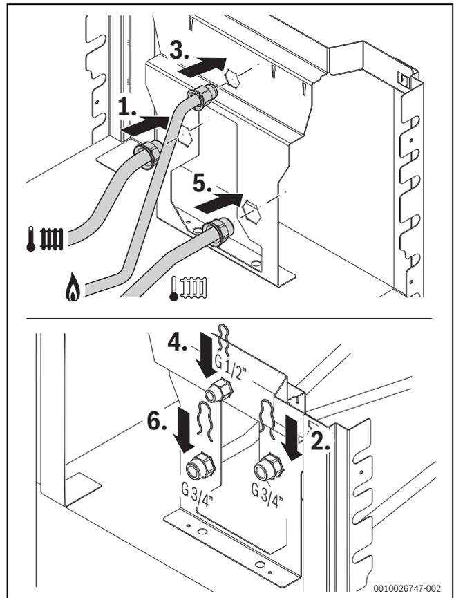
Fig. 47 Installazione sul retro di mandata riscaldamento, tubo del gas e ritorno riscaldamento (accessorio CS 35)
