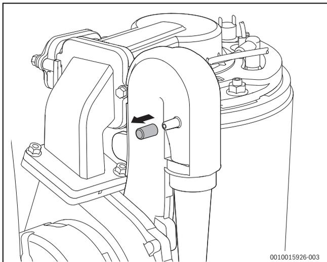
Fig. 109 Manicotto di misurazione sul miscelatore
