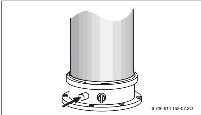
Fig. 99 Rimozione del tappo
