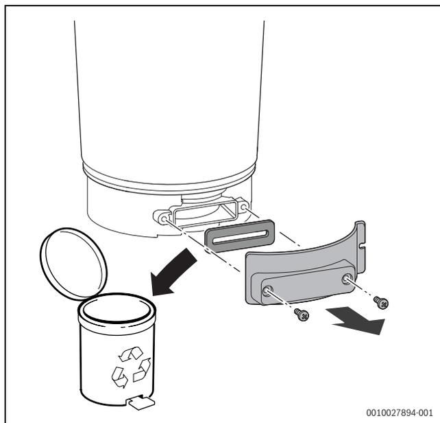
Fig. 123 Apertura dell'apertura di ispezione
