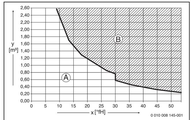
Fig. 39 Requisiti per l'acqua di riempimento e di reintegro in °fH per apparecchi < 50 kW
