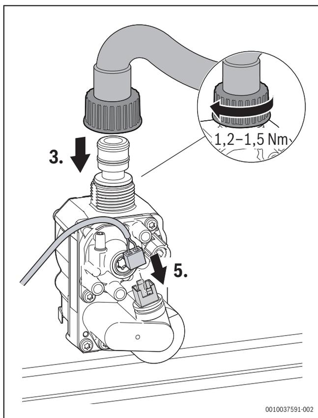
Fig. 139 Collegamento di tubo flessibile del gas e connettore – Rispettare la coppia di serraggio
