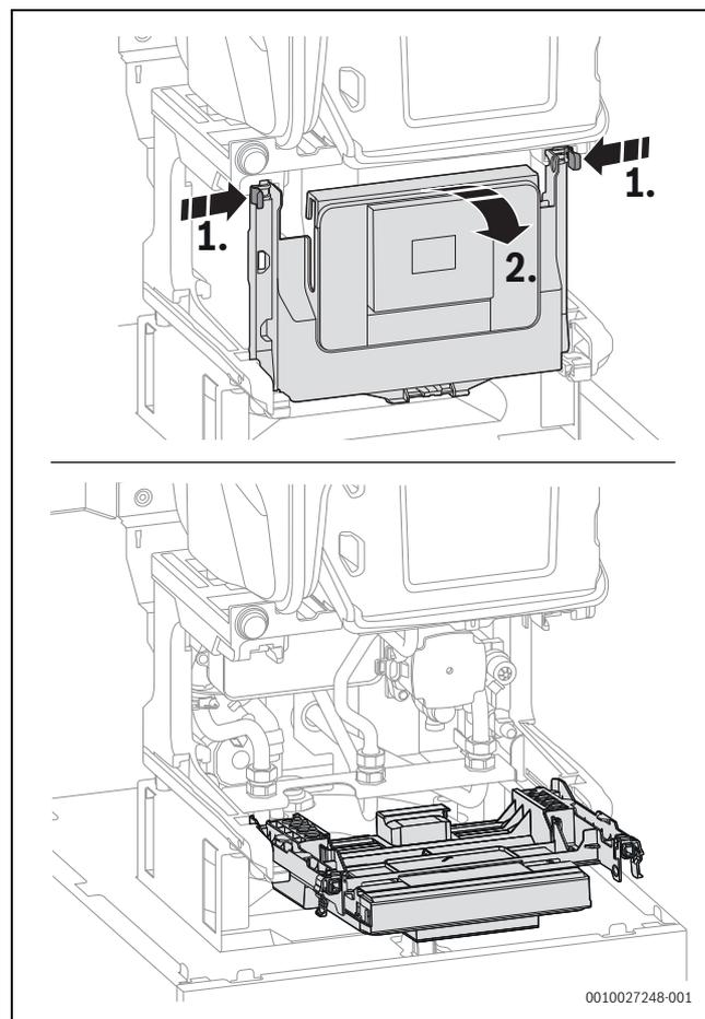
Fig. 108 Rotazione verso il basso del dispositivo di controllo
