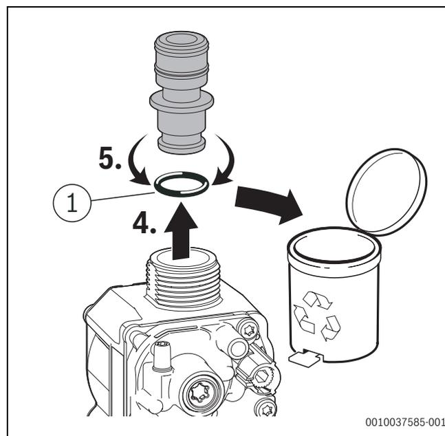
Fig. 133 Rimozione dell'ugello del gas
