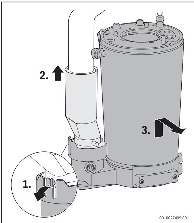
Fig. 127 Smontaggio dello scambiatore primario
