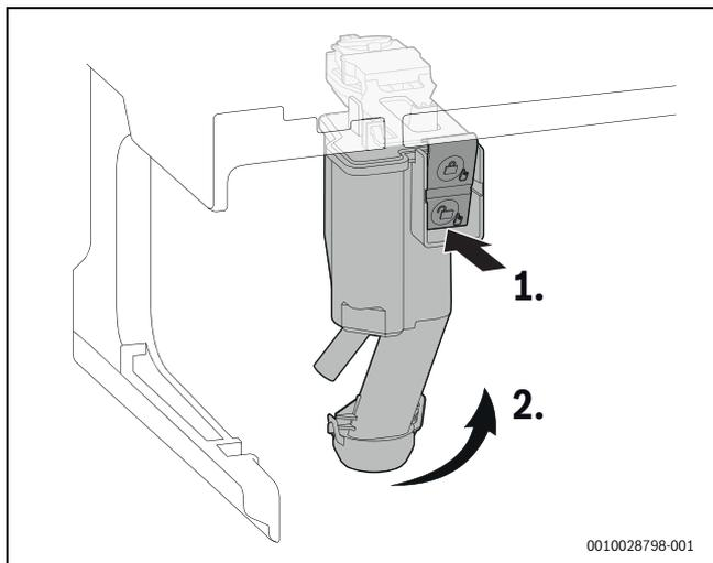
Fig. 58 Rimuovere il sifone per la condensa
