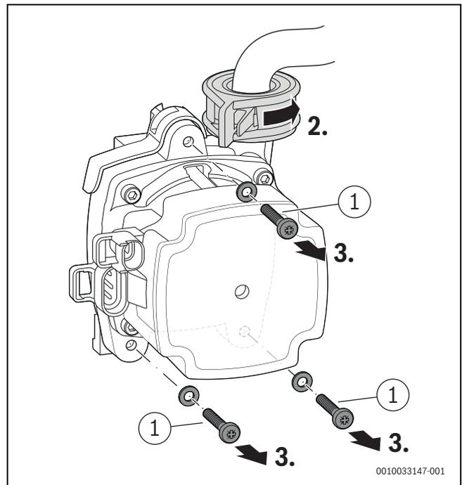
Fig. 129 Sbloccaggio del circolatore riscaldamento e rimozione delle viti
