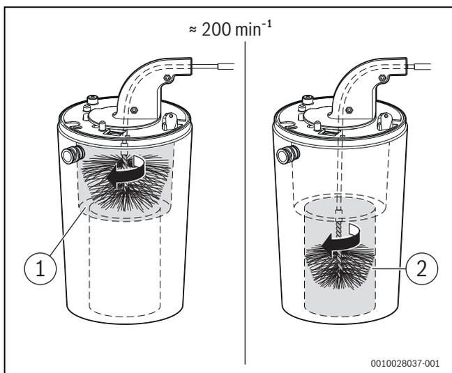
Fig. 122 Pulizia dello scambiatore primario (circa  $200 \text{ min}^{-1}$ , solo rotazione destrorsa)
