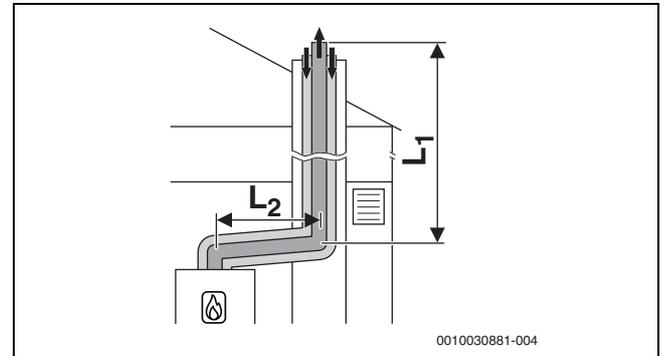
Fig. 21 Condotto di aspirazione aria comburente/evacuazione prodotti della combustione concentrico secondo C<sub>33x</sub> nel cavedio
