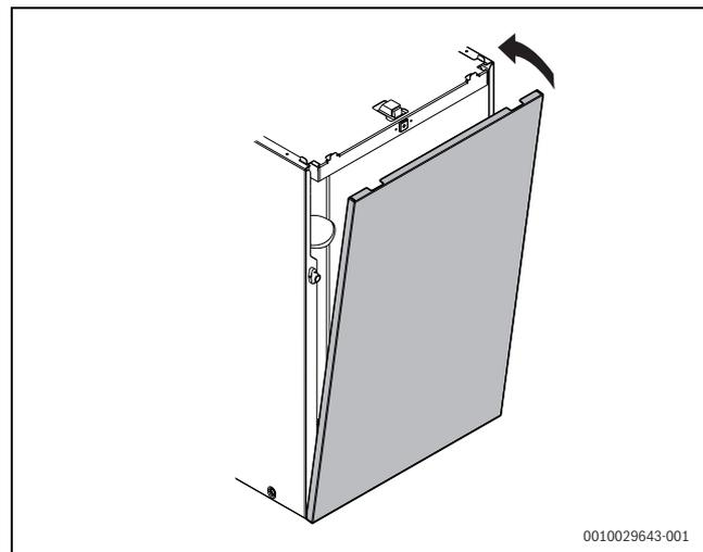
Fig. 95 Chiusura del pannello anteriore del mantello del bollitore
