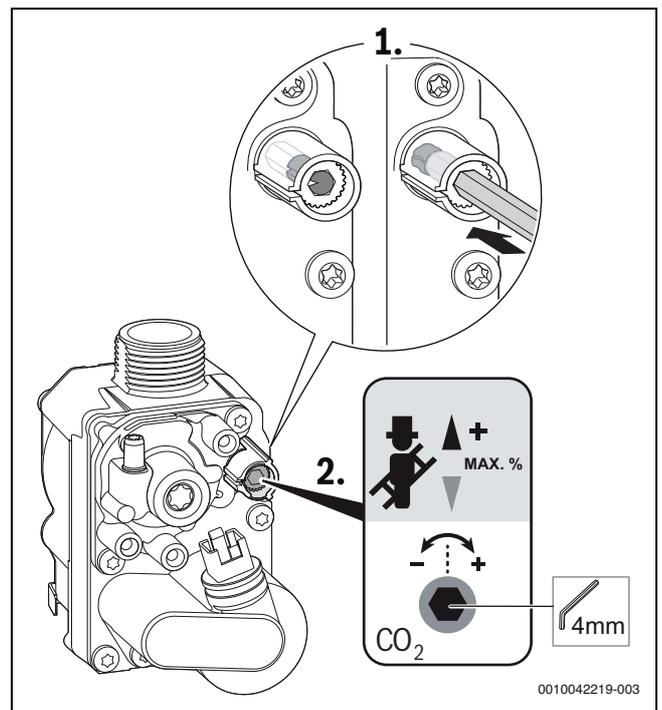
Fig. 100 Taratura del tenore di CO<sub>2</sub>/O<sub>2</sub> a potenza termica nominale massima
