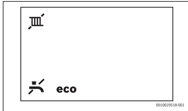
Fig. 94 Riscaldamento e produzione di acqua calda sanitaria spenti
