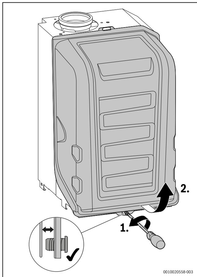
Fig. 71 Rimozione della cuffia del bruciatore
