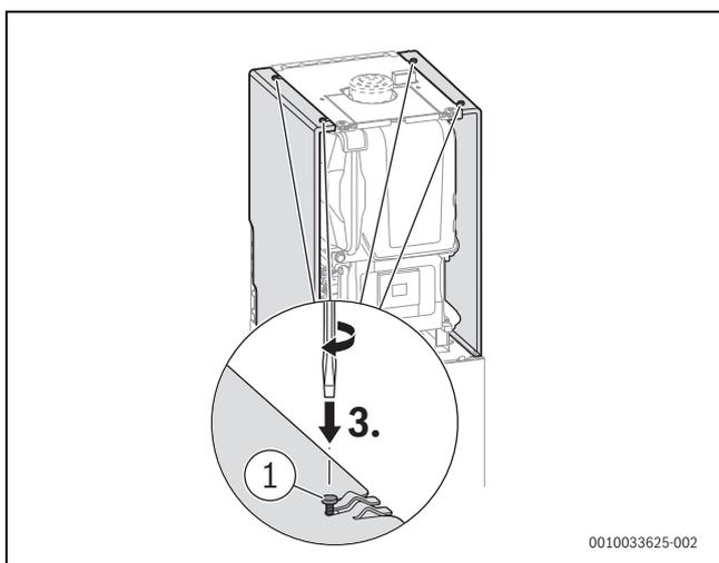
Fig. 86 Fissaggio dei pannelli laterali del mantello
