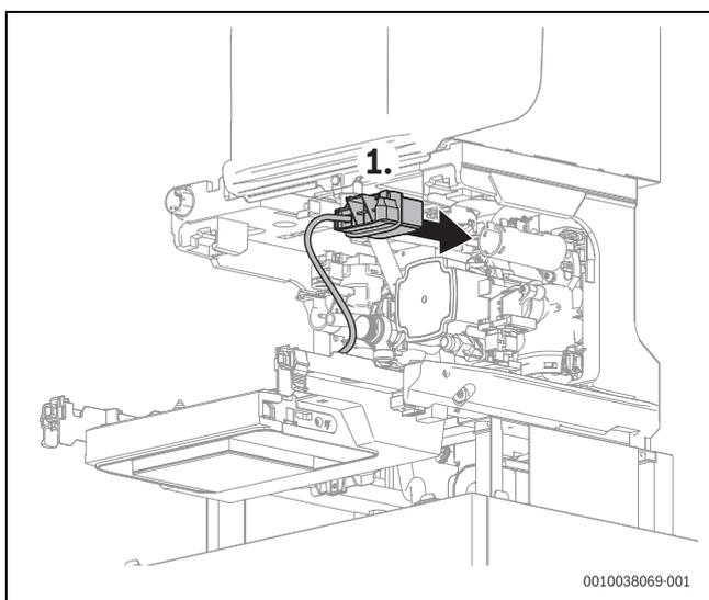
Fig. 63 Introdurre il supporto per Key dal lato posteriore dell'apparecchio
