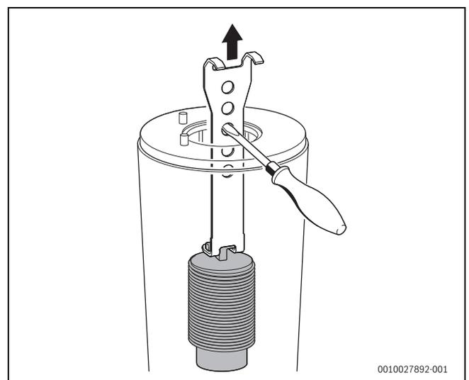
Fig. 119 Estrazione del deviatore di fiamma inferiore
