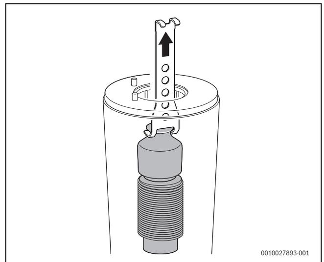
Fig. 118 Estrazione del deviatore di fiamma superiore
