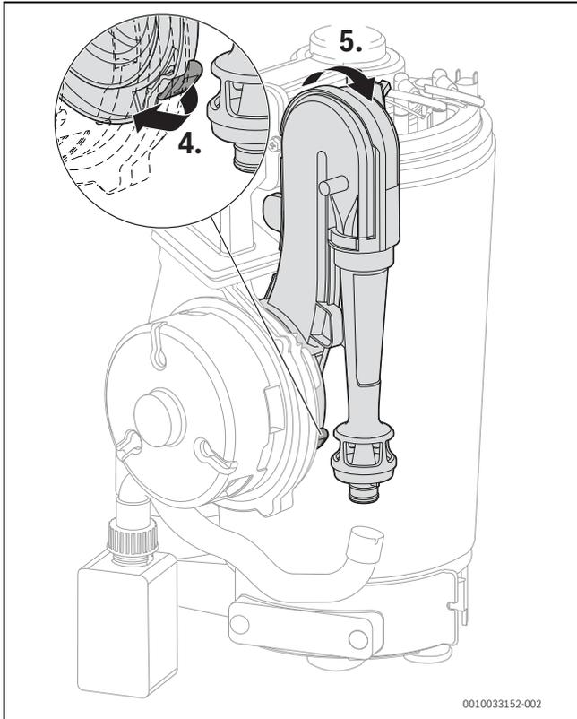
Fig. 112 Rimozione del tubo di Venturi
