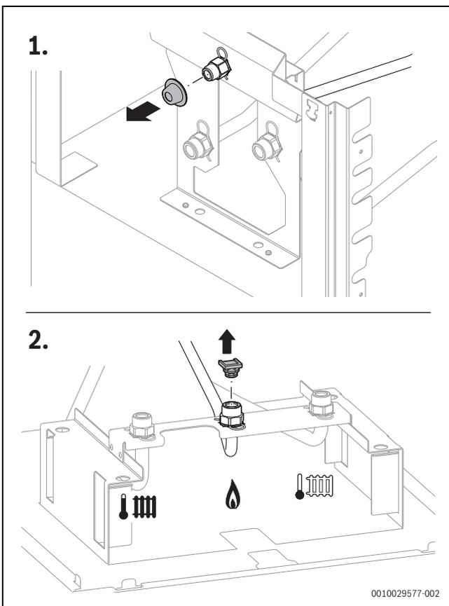
Fig. 49 Togliere il cappuccio protettivo e il tappo sul tubo del gas
