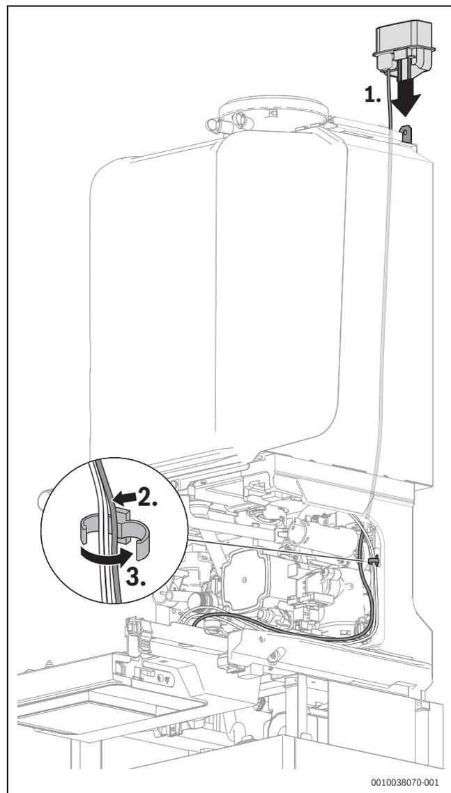
Fig. 64 Inserire il supporto per Key nella sede per l'innesto e fissare il cavo conduttore nel fermacavi
