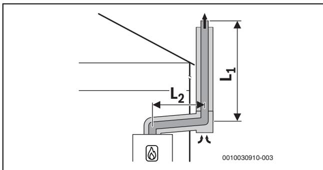
Fig. 26 Condotto di aspirazione aria comburente/evacuazione prodotti della combustione concentrico secondo C<sub>53x</sub> sulla parete esterna
