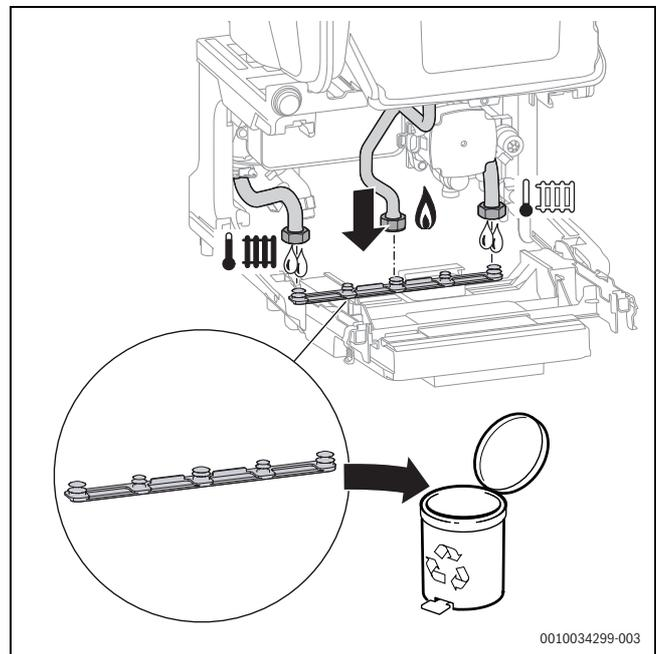
Fig. 54 Rimozione del listello di copertura dall'apparecchio
