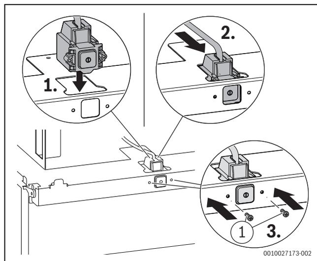
Fig. 74 Fissaggio dell'interruttore on/off
