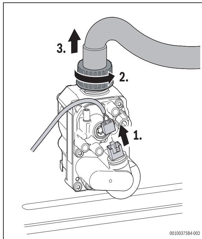
Fig. 132 Scollegamento del connettore dalla valvola del gas e rimozione del dado a risvolto con il tubo flessibile del gas
