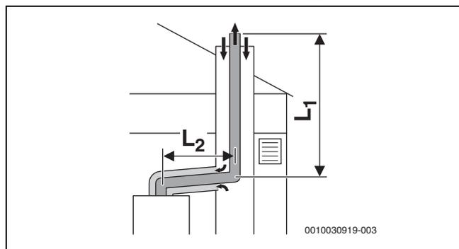
Fig. 27 Sistema fumario rigido secondo C<sub>93x</sub> nel cavedio e condotto di aspirazione aria comburente/evacuazione prodotti della combustione concentrico nel luogo di posa
