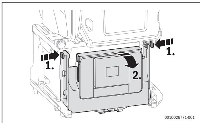
Fig. 57 Rotazione verso il basso del dispositivo di controllo
