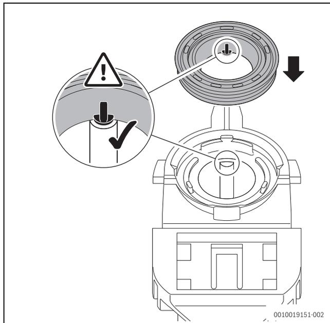
Fig. 142 Allineamento della nuova guarnizione sul sifone per la condensa
