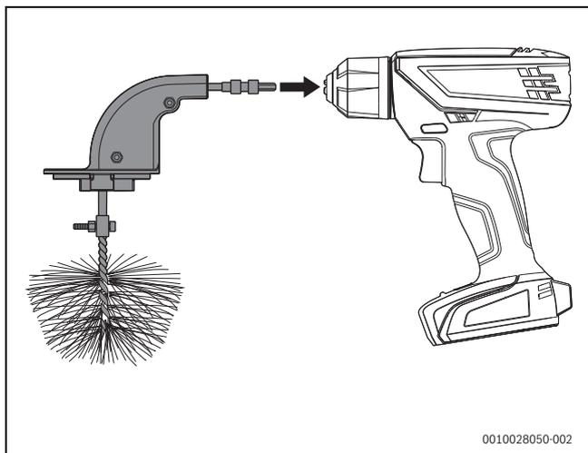
Fig. 121 Montaggio della spazzola sull'avvitatore a batteria
