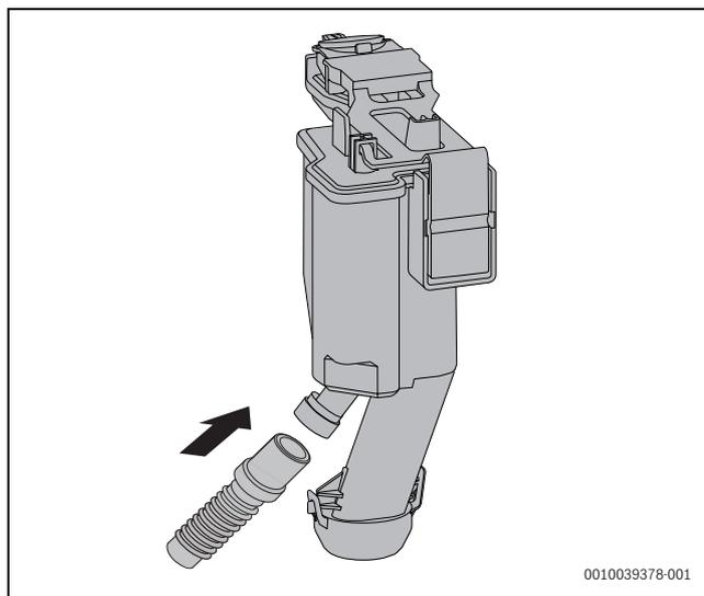
Fig. 68 Collegamento del tubo flessibile al sifone per la condensa
