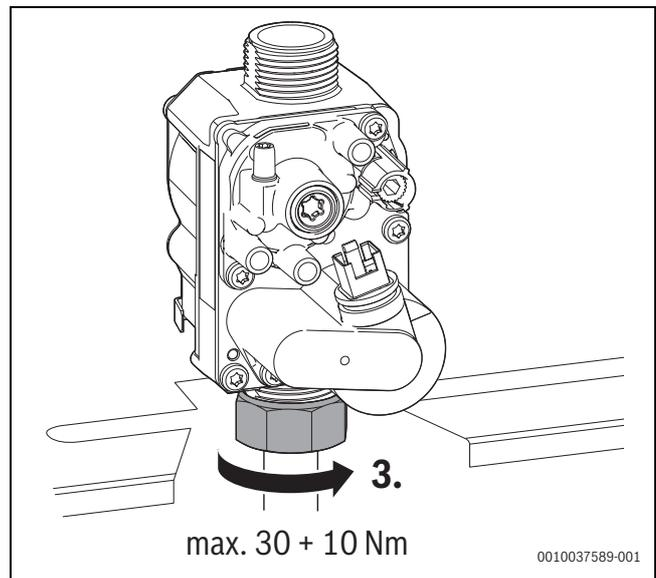
Fig. 137 Rispettare la coppia di serraggio
