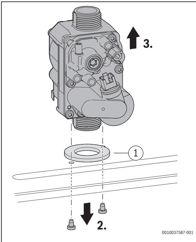
Fig. 135 Smontaggio della valvola del gas
