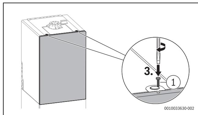
Fig. 88 Fissare il pannello anteriore del mantello con una vite inclusa nel volume di fornitura
