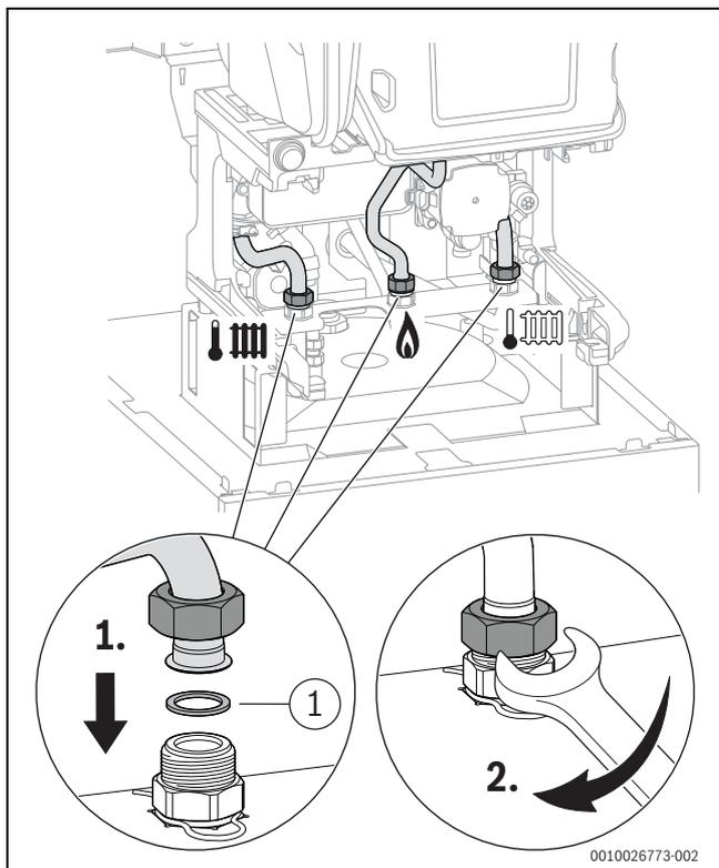
Fig. 59 Collegare mandata riscaldamento, gas, ritorno riscaldamento
