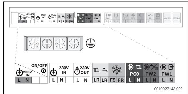
Fig. 80 Lato tensione elettrica di rete: morsettiera
