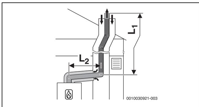
Fig. 28 Sistema fumario flessibile secondo C<sub>93x</sub> nel cavedio e condotto di aspirazione aria comburente/evacuazione prodotti della combustione concentrico nel luogo di posa
