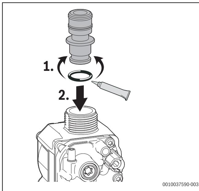
Fig. 138 Applicazione dell'ugello del gas
