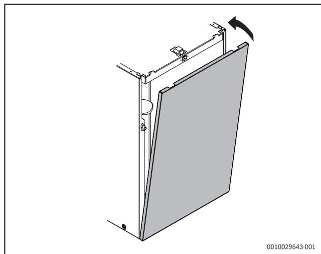
Fig. 75 Chiusura del pannello anteriore del mantello del bollitore
