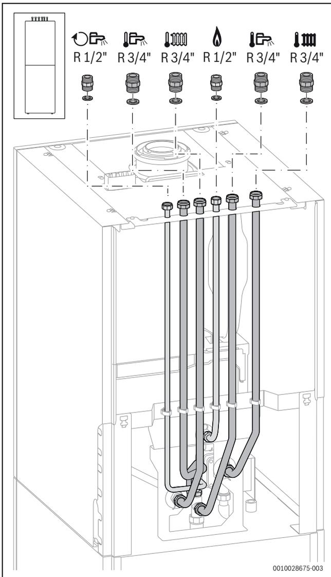
Fig. 52 Accessorio CS 33 montato
