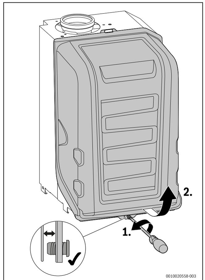
Fig. 97 Rimozione della cuffia del bruciatore
