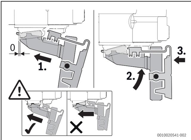
Fig. 144 Montaggio del sifone per la condensa
