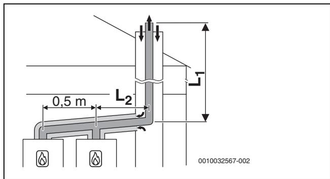
Fig. 36 Impianto a cascata con 2 apparecchi: sistema di aspirazione aria/evacuazione dei prodotti della combustione rigido secondo C<sub>93x</sub> nel cavedio e condotto di aspirazione aria comburente/evacuazione prodotti della combustione concentrico nel luogo di posa
