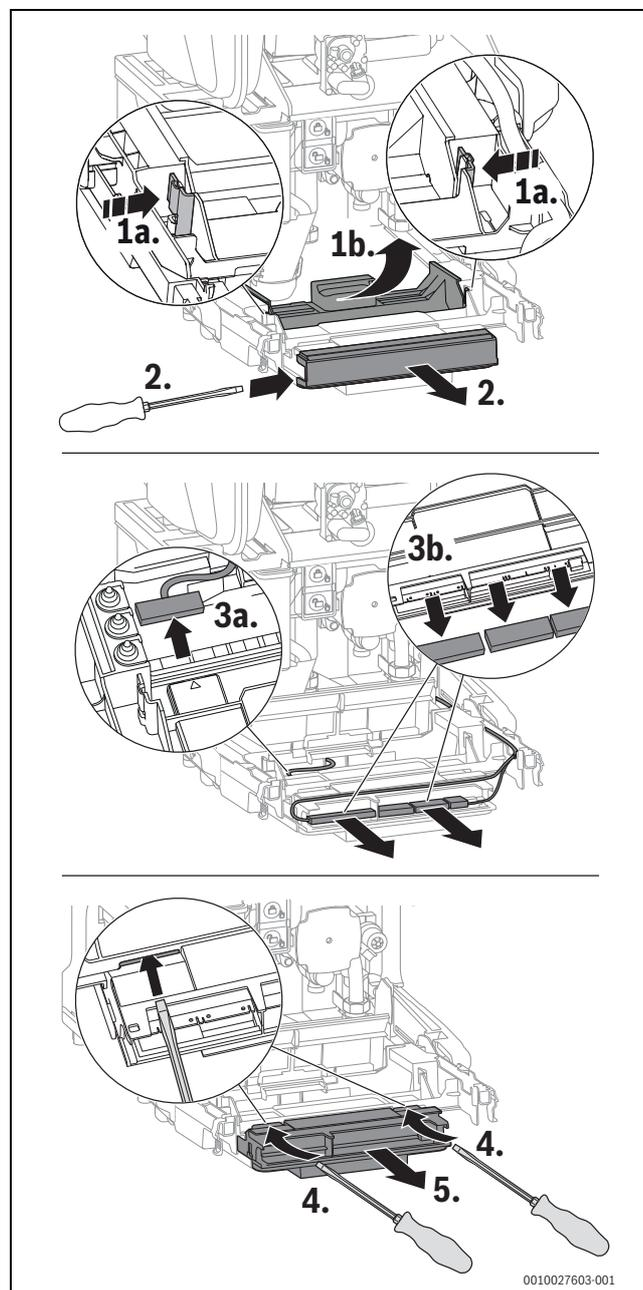
Fig. 140 Rimozione del dispositivo di controllo
