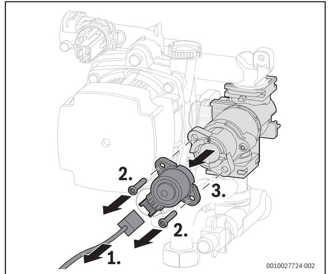
Fig. 146 Smontaggio del motorino dalla valvola a 3 vie
