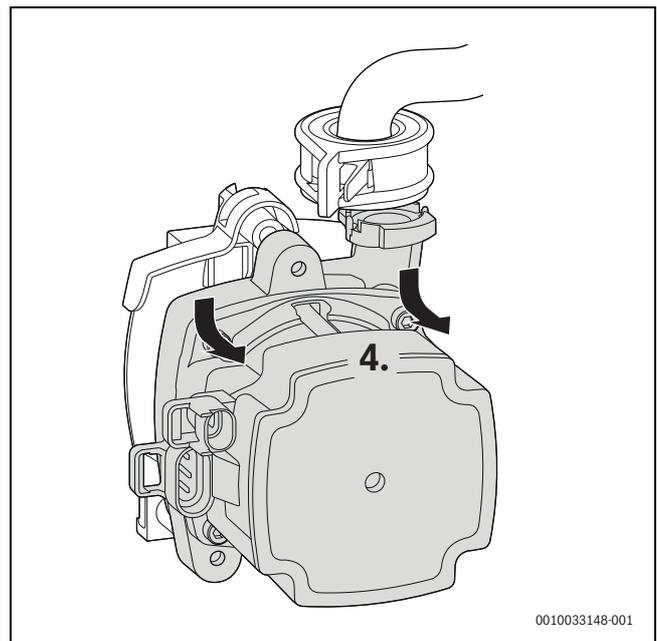
Fig. 130 Rimozione del circolatore riscaldamento
