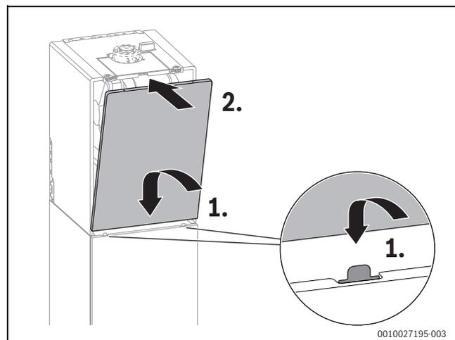
Fig. 87 Applicazione del pannello anteriore del mantello dell'apparecchio
