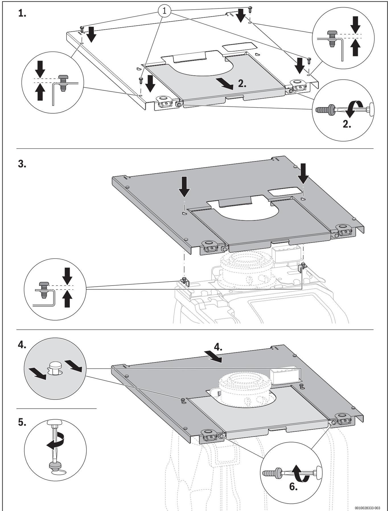
Fig. 84 Fissare le parti superiori del mantello. Se necessario, le due parti del mantello possono essere applicate in successione.
