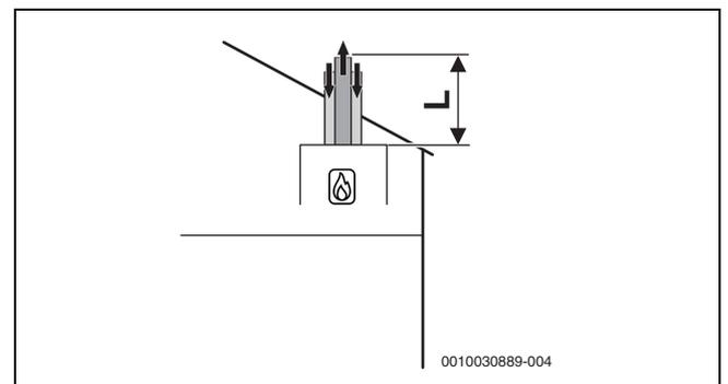
Fig. 22 Condotto di aspirazione aria comburente/evacuazione prodotti della combustione verticale concentrico secondo C<sub>33x</sub>
