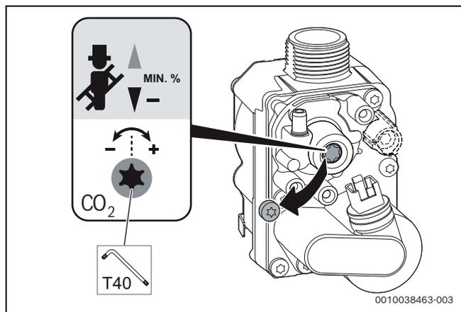
Fig. 101 Taratura del tenore di CO<sub>2</sub>/O<sub>2</sub> a potenza termica nominale minima
