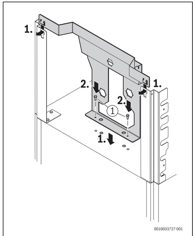
Fig. 46 Installazione di Modulo base (accessorio CS 35) – fase 2
