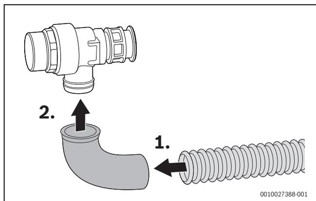
Fig. 67 Collegamento del tubo flessibile alla valvola di sicurezza
