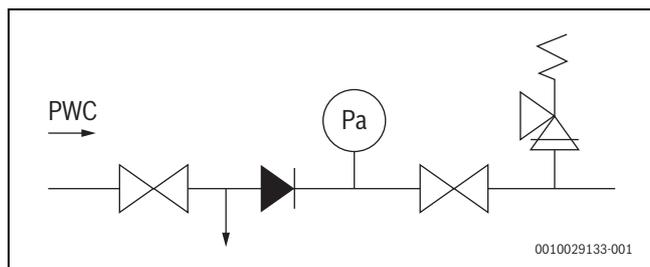
Fig. 66 Esempio: gruppo sicurezze per acqua di espansione a norma EN 1488
