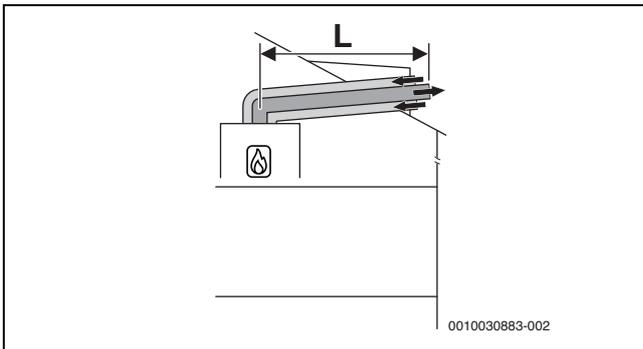
Fig. 20 Condotto di aspirazione aria comburente/evacuazione prodotti della combustione orizzontale concentrico secondo C<sub>13x</sub> attraverso il tetto
