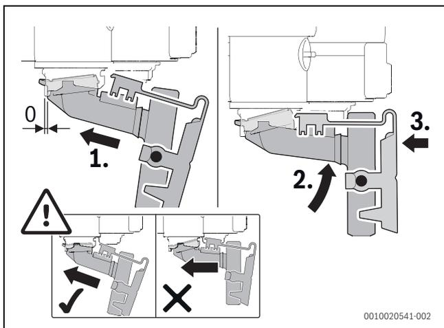
Fig. 62 Applicare di nuovo il sifone per la condensa e controllarne il saldo alloggiamento in sede
