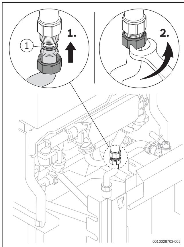
Fig. 61 Collegare il tubo acqua calda sanitaria del circuito di carico al bollitore
