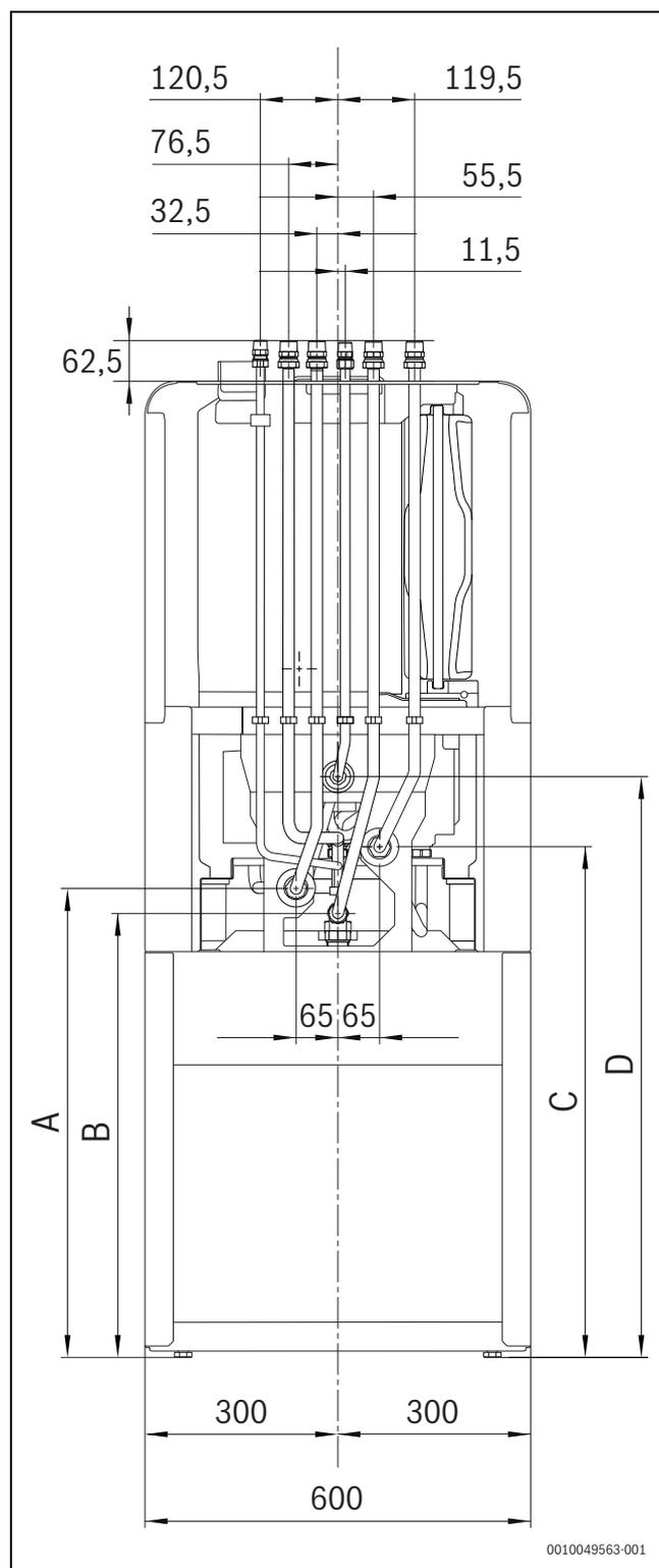
Fig. 12 Vista del lato posteriore (misure in mm)
