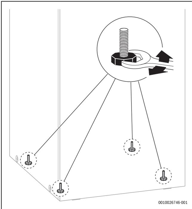
Fig. 90 Compensazione dei dislivelli con i piedini regolabili sul luogo di installazione definitivo
