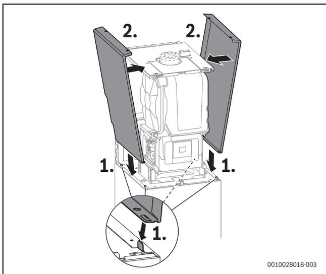
Fig. 85 Applicazione dei pannelli laterali del mantello dell'apparecchio
