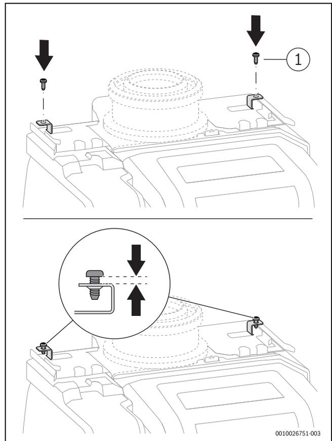
Fig. 53 Avvitare le viti per il lato superiore del mantello dell'apparecchio, senza serrarle
