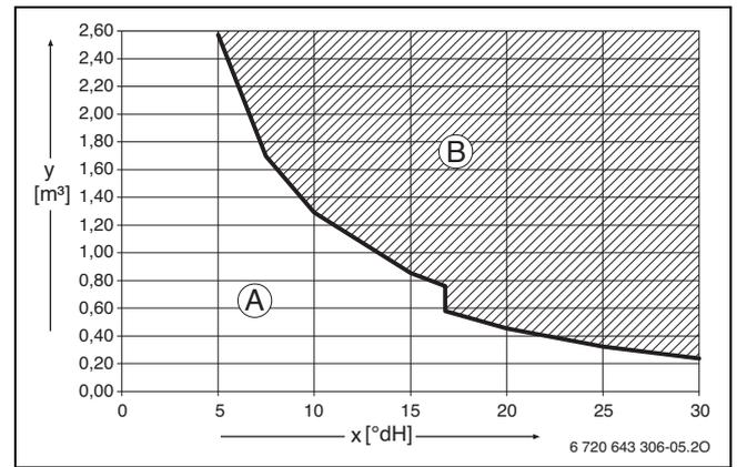
Fig. 38 Requisiti per l'acqua di riempimento e di reintegro in °dH per apparecchi < 50 kW
