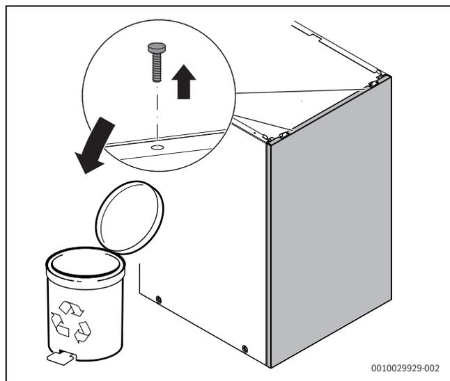
Fig. 42 Rimozione della sicurezza per il trasporto sul pannello anteriore del mantello del bollitore
