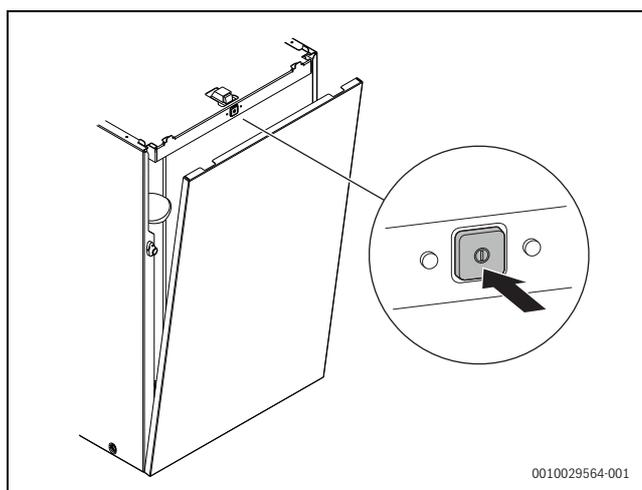
Fig. 104 Accensione dell'apparecchio con l'interruttore on/off
