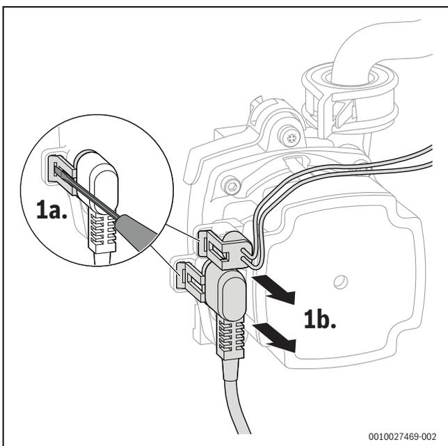
Fig. 128 Scollegamento del connettore dal circolatore riscaldamento
