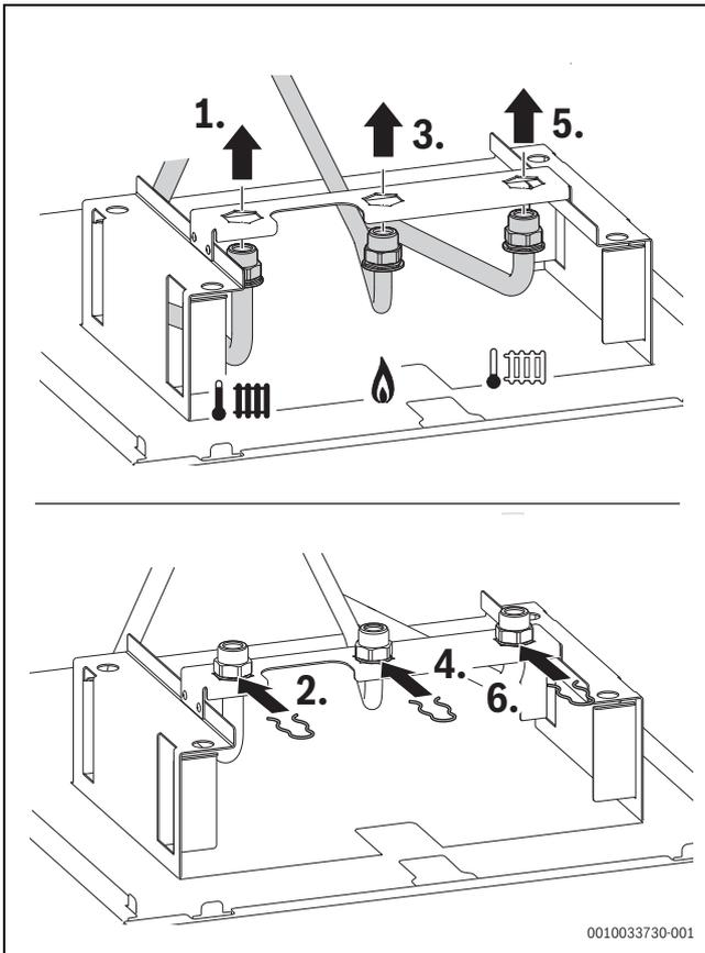
Fig. 48 Installazione sul lato anteriore di mandata riscaldamento, tubo del gas e ritorno riscaldamento (accessorio CS 35)
