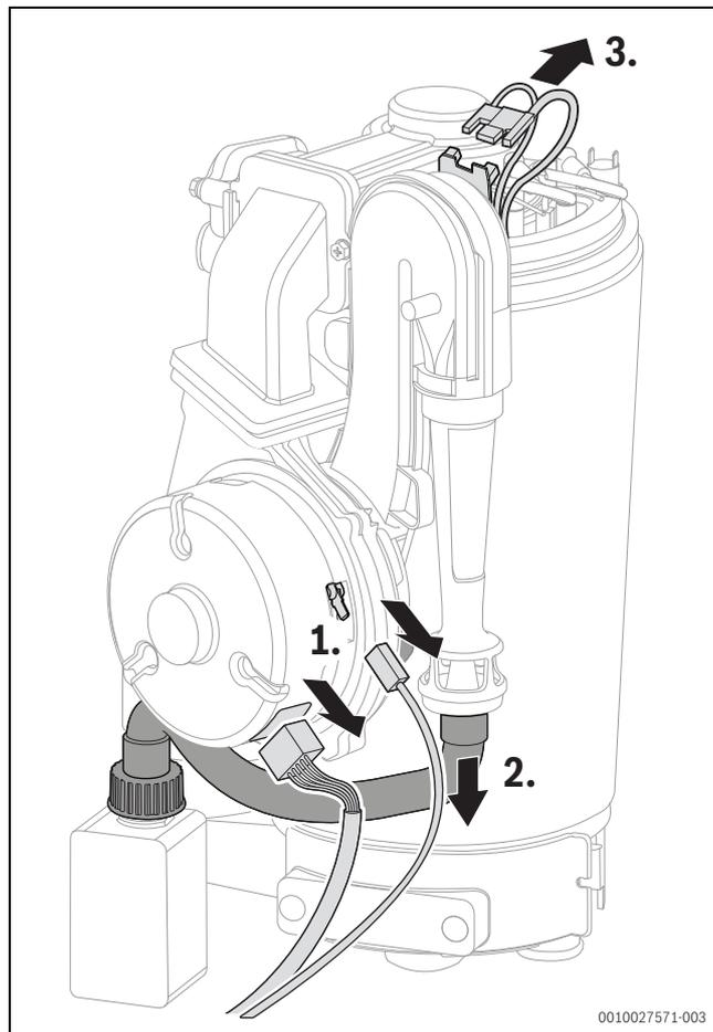
Fig. 111 Scollegamento di connettore elettrodi d'accensione e tubo flessibile del gas
