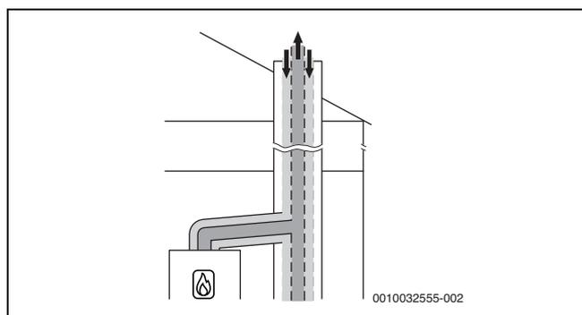
Fig. 23 Condotto di aspirazione aria comburente/evacuazione prodotti della combustione concentrico secondo C<sub>43x</sub> nel luogo di posa
