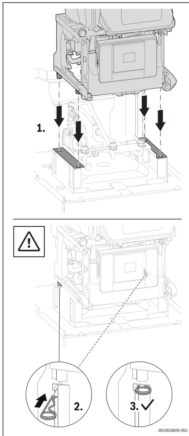
Fig. 56 Posizionare l'apparecchio sul bollitore e assicurarlo con 2 coppiglie
