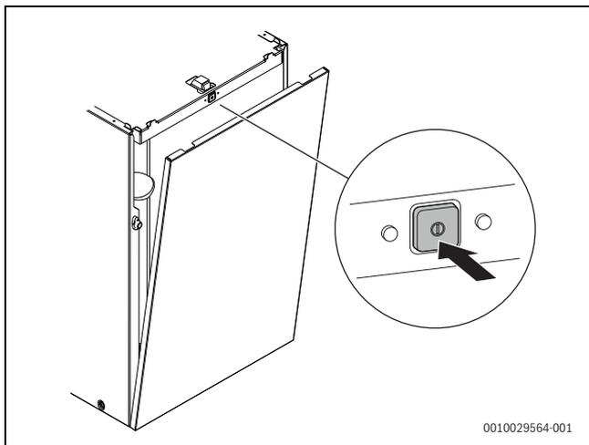
Fig. 93 Accensione dell'apparecchio con l'interruttore on/off
