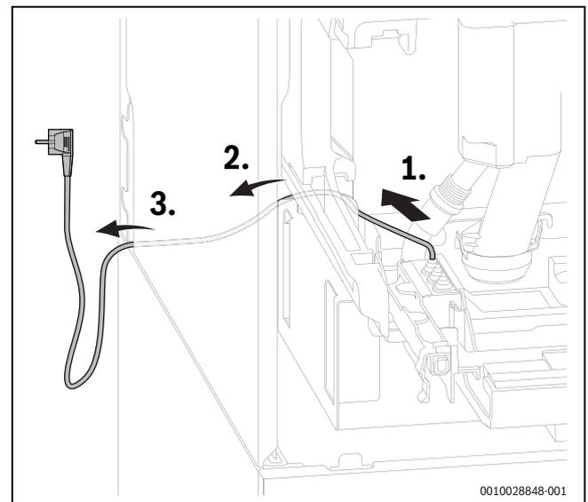
Fig. 83 Passaggio del cavo di rete
