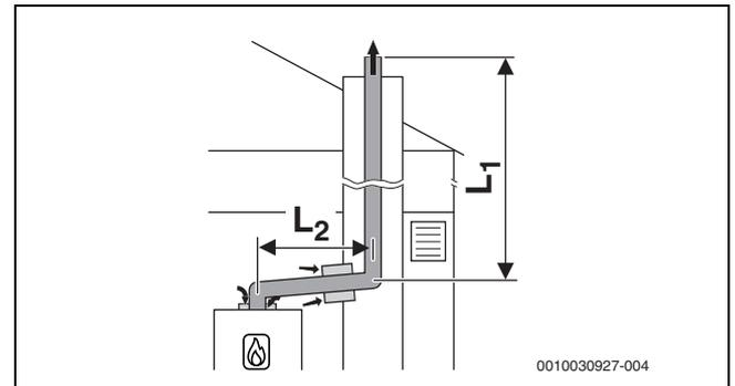
Fig. 29 Sistema fumario rigido nel cavedio, secondo B<sub>53P</sub> con adduzione aria comburente sull'apparecchio e dipendente dall'aria del locale e con elemento di collegamento concentrico tra luogo di posa e cavedio
