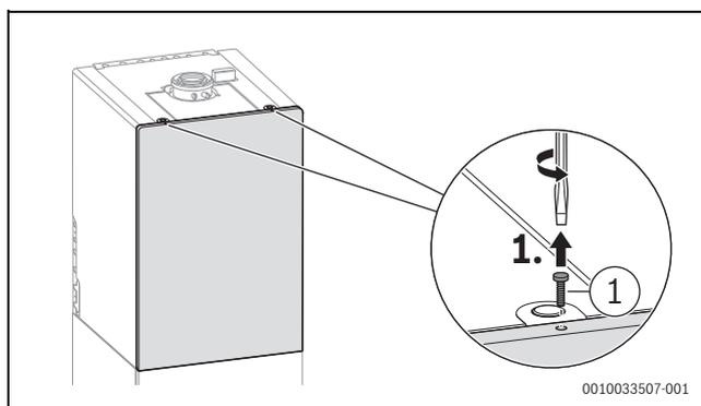
Fig. 105 Rimozione della vite di sicurezza
