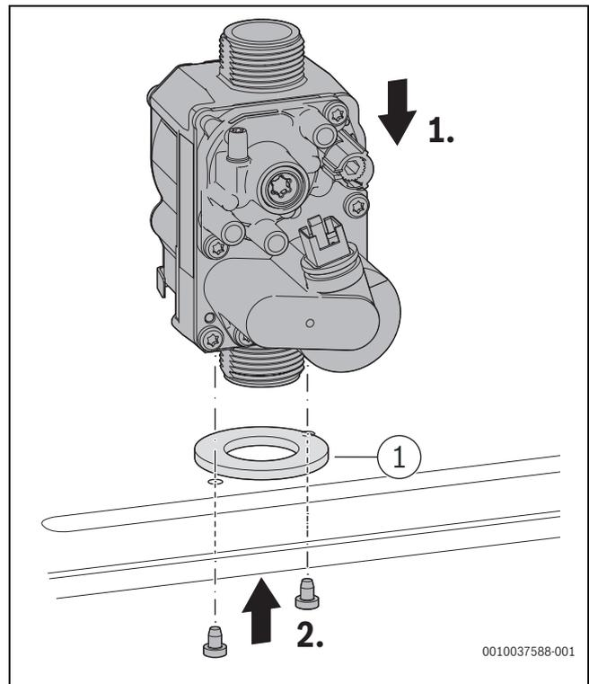
Fig. 136 Montaggio della valvola del gas
