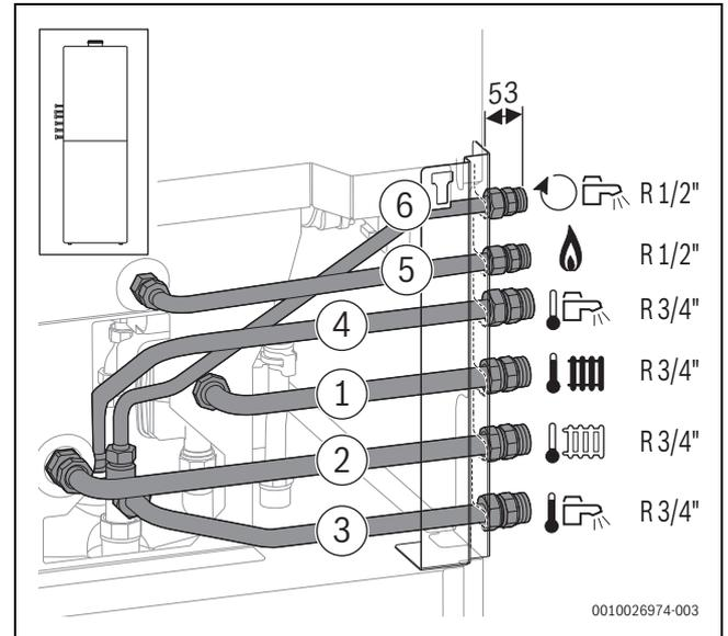
Fig. 50 Accessorio CS 10 montato sul lato sinistro
