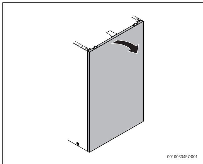
Fig. 73 Apertura della parte anteriore del mantello del bollitore
