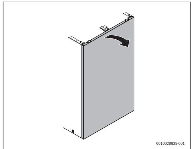
Fig. 92 Apertura della parte anteriore del mantello del bollitore
