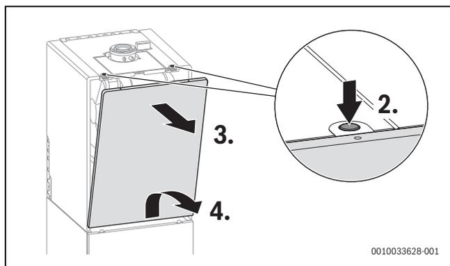
Fig. 106 Rimozione del pannello anteriore del mantello
