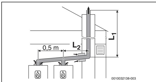
Fig. 35 Impianto a cascata con 2 apparecchi: sistema fumario rigido nel cavedio secondo B<sub>53P</sub> con adduzione aria comburente sull'apparecchio dipendente dall'aria del locale
