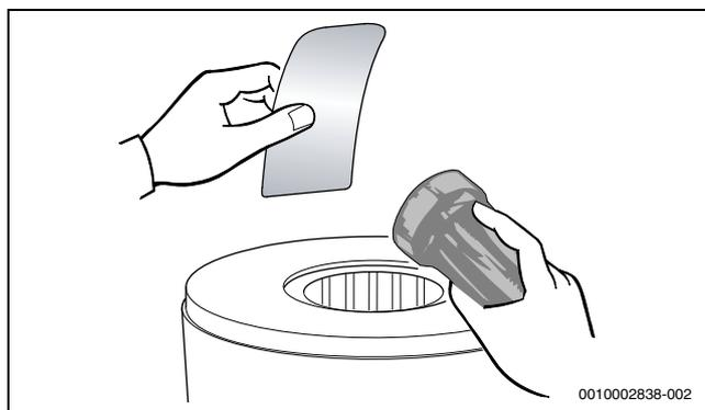
Fig. 124 Controllo della presenza di residui nello scambiatore primario
