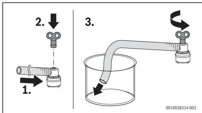
Fig. 72 Sfiato del circuito dell'acqua calda sanitaria e di riscaldamento
