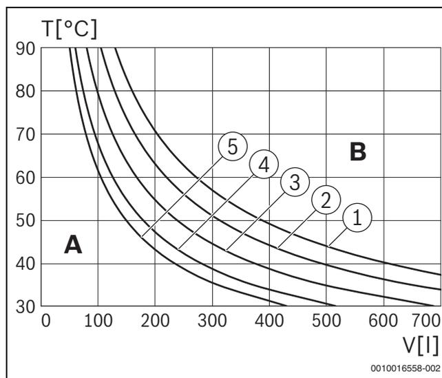
Fig. 40 Curve caratteristiche del vaso d'espansione (12 l)
