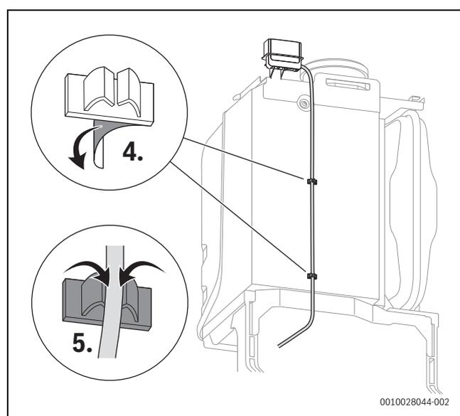
Fig. 65 Applicare il fermacavi sul lato posteriore dell'apparecchio e fissare il cavo conduttore
