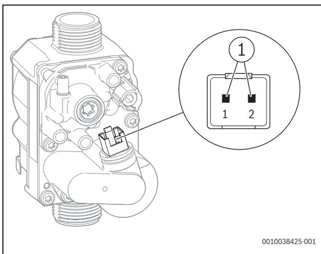
Fig. 110 Punti di misurazione sulla valvola del gas
