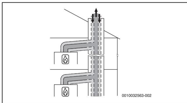
Fig. 31 Collettore scarico gas combusti secondo C<sub>(10)3x</sub> con condotto di aspirazione aria comburente/evacuazione prodotti della combustione concentrico nel luogo di posa**3.17.4 Condotto fumario secondo C<sub>(12)3x</sub>**
