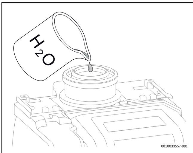
Fig. 70 Riempimento del sifone per la condensa con acqua
