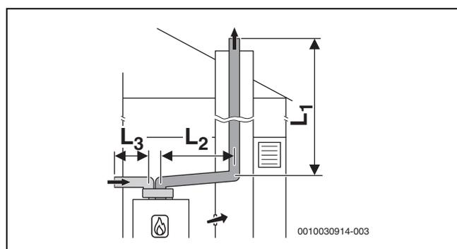
Fig. 24 Sistema fumario rigido secondo C<sub>53</sub> nel cavedio e condotto di aspirazione aria comburente/evacuazione pdc con tubi separati per adduzione aria ed evacuazione pdc nel luogo di posa
