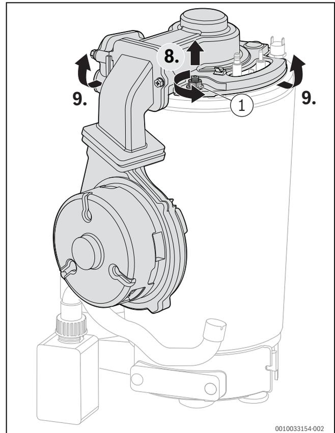
Fig. 114 Rimozione del coperchio del bruciatore con ventilatore e miscelatore
