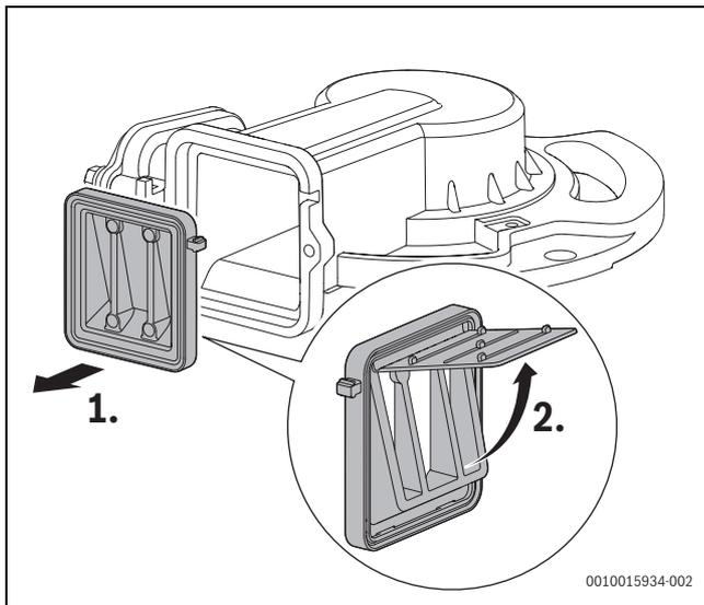
Fig. 116 Protezione antiriflusso nel miscelatore
