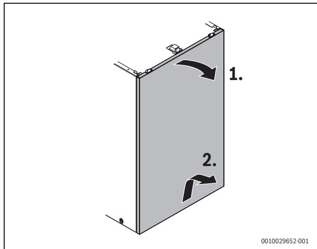
Fig. 147 Rimuovere il pannello anteriore del mantello del bollitore e sistemarlo al sicuro
