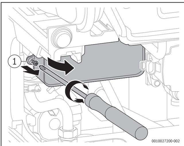
Fig. 145 Smontaggio dello scambiatore di calore a piastre
