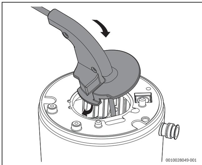
Fig. 120 Introduzione della spazzola nello scambiatore primario
