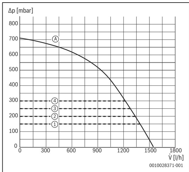
Fig. 150 Campi di lavoro e curva caratteristica del circolatore (17/24 kW)
