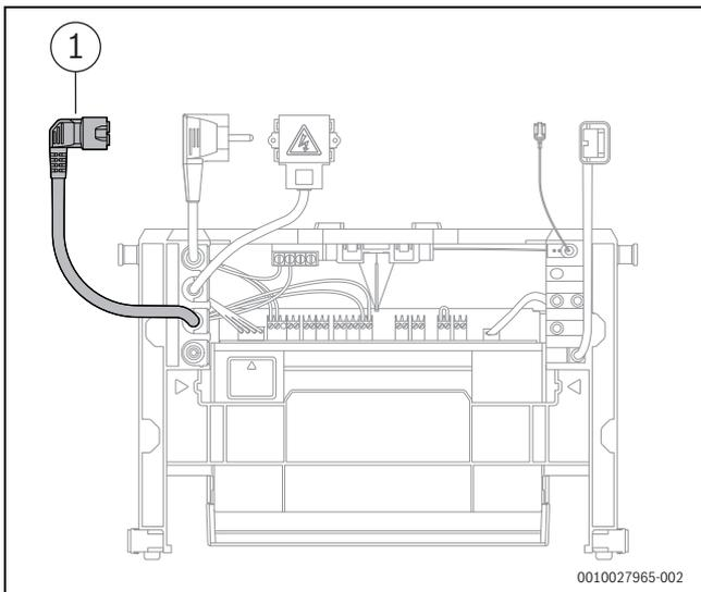
Fig. 78 Sede per l'innesto del cavo di collegamento della pompa di carico bollitore
