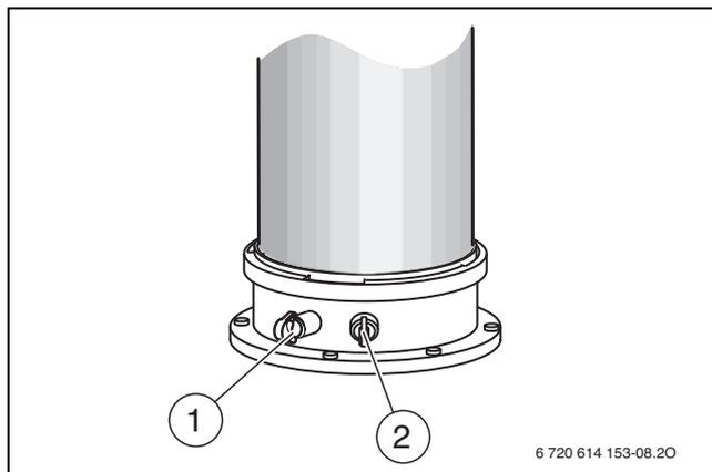
Fig. 102 Tronchetto di misurazione gas combustibili e tronchetto di misurazione per aria comburente
