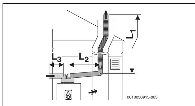
Fig. 25 Sistema fumario flessibile secondo C<sub>53</sub> nel cavedio e condotto di aspirazione aria comburente/evacuazione pdc con tubi separati per adduzione aria ed evacuazione pdc nel luogo di posa
