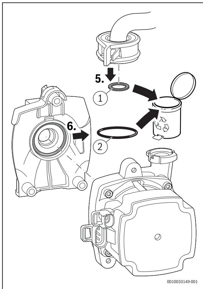
Fig. 131 Smaltimento delle guarnizioni
