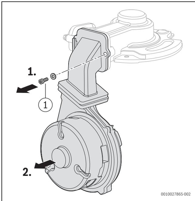
Fig. 115 Smontaggio di miscelatore e ventilatore
