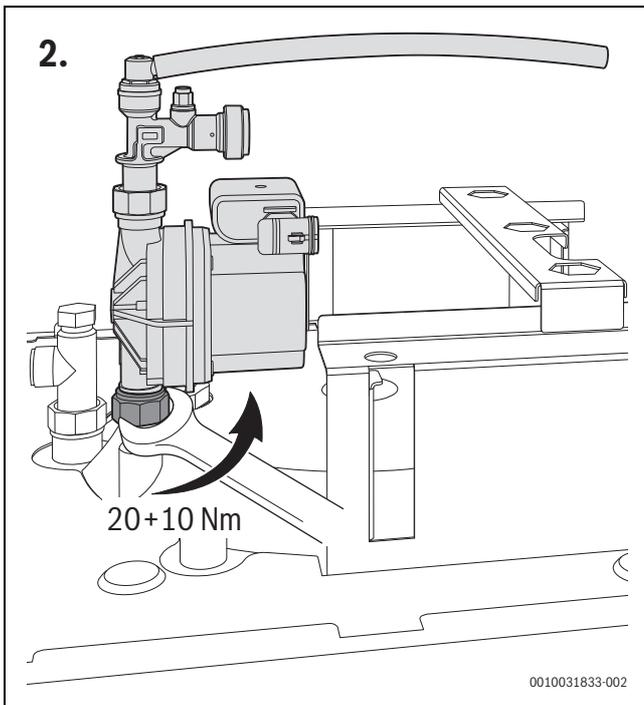
Fig. 44 Rispettare la coppia di serraggio
