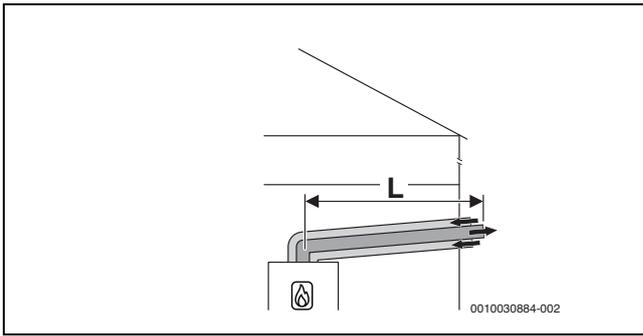
Fig. 19 Condotto di aspirazione aria comburente/evacuazione pdc orizzontale concentrico secondo C<sub>13x</sub> attraverso la parete esterna
