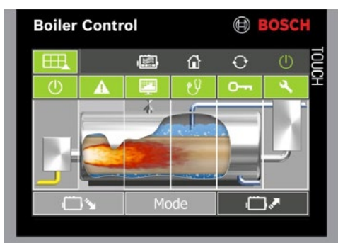
BCO pro řízení parních kotlů
