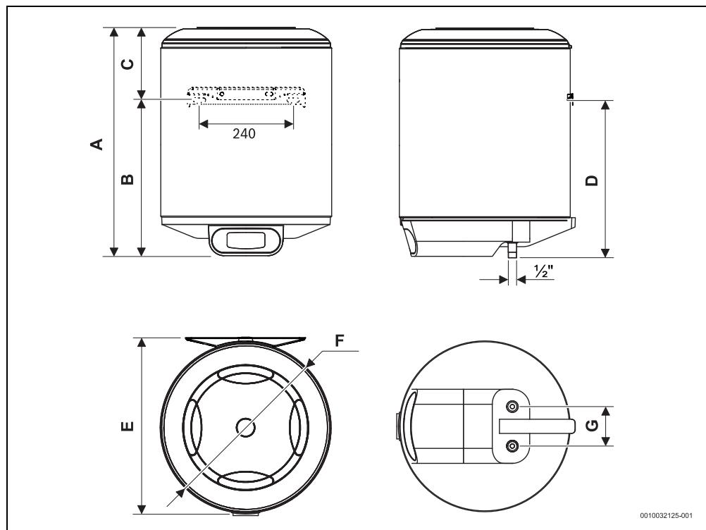
Fig. 2 Dimensions en mm (installation murale, montage vertical)
