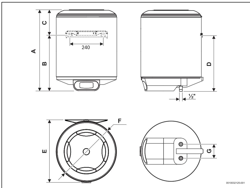
sl. 2 Dimenziije u mm (zidna montaža, vertikalni sklop)
