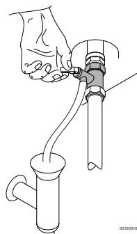
Sl. 6 Odpiranje tlačnega varnostnega ventila
