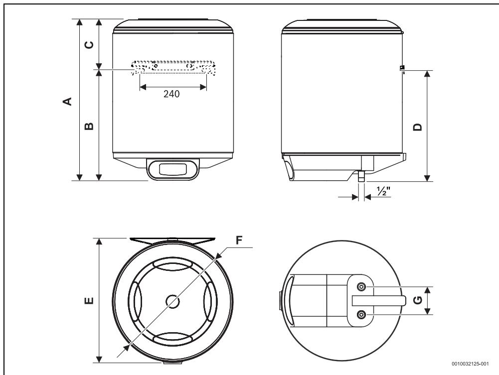
2. ábra Méretek mm-ben (fali akasztós, függőleges szerelés)
