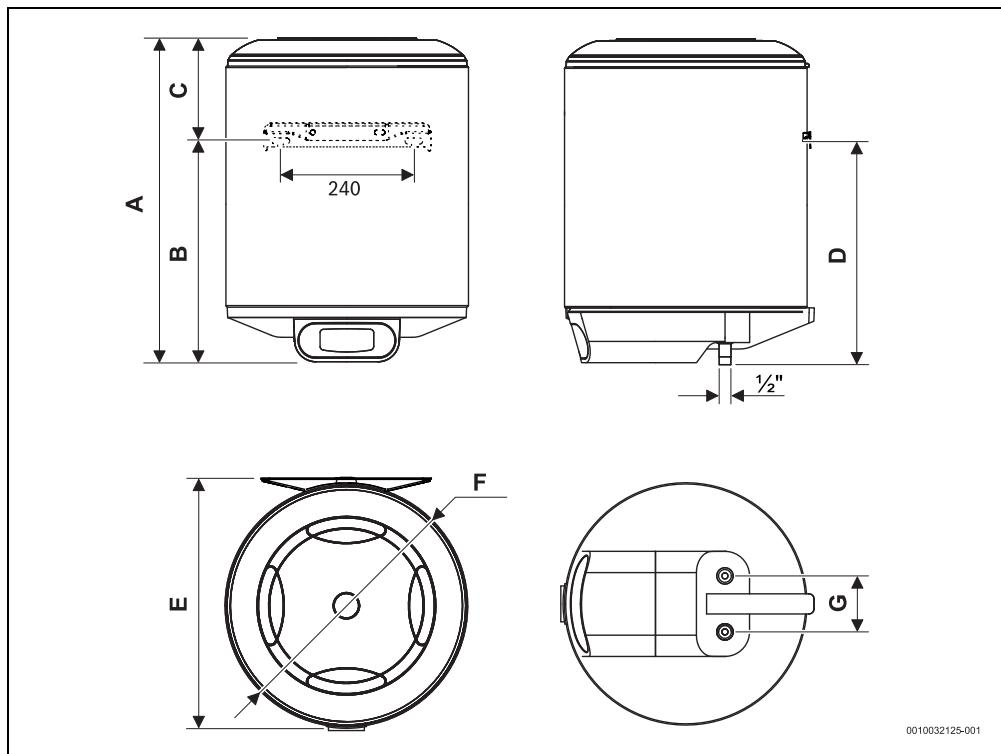
Мал. 2 Розміри в мм (настінний, вертикальний монтаж)
