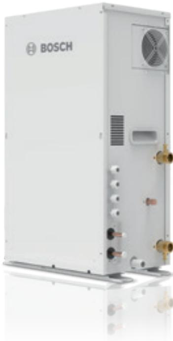
L'Hydro Box AF-HB 140-1 è l'unità interna Air Flux per la produzione di acqua calda, abbinabile all'unità esterna AF6300A C. L'Hydro Box ha un secondo circuito di refrigerazione (R-134a), che comprende quindi un compressore. In un sistema dotato di Hydro Box, devono essere collegate anche le unità interne VRF (che devono essere pari ad almeno il 50% della potenza delle unità interne).
