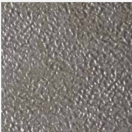
Obrázok 6: Vonkajší plášť zo štrukturovaného hliníkového plechu
