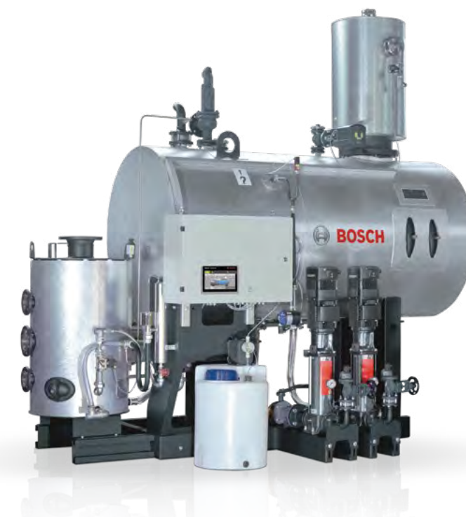
Obr. 197 Modul tepelné úpravy vody WSM-V k plnému odplynění pro všechny parní kotle s výkonem 2 000 až zhruba 100 000 kg/h
