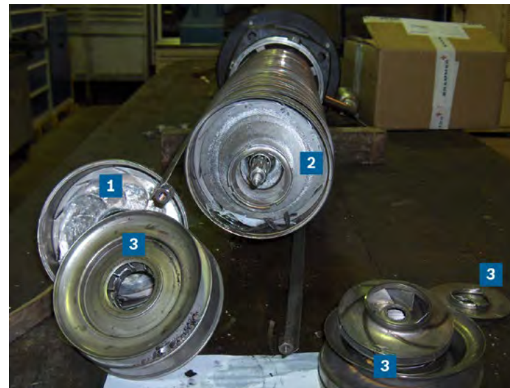
Obr. 26 Poškození čerpadel kavitací
