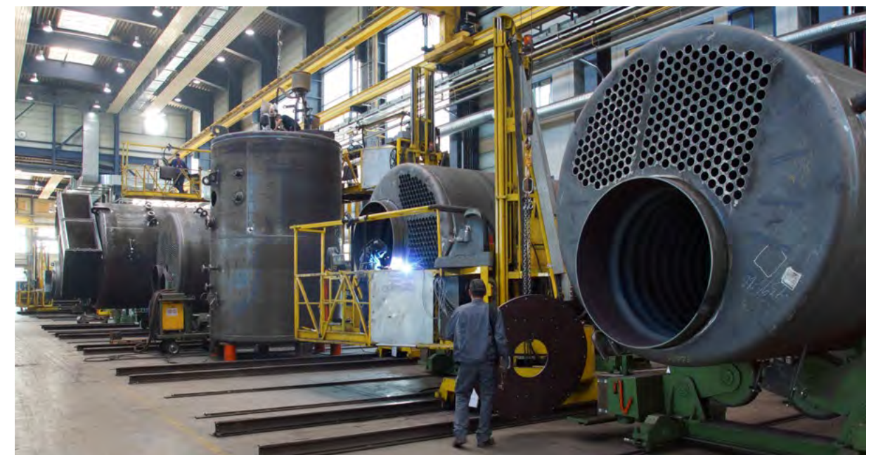
Obr. 131 Ležící a stojící těleso kotle ve výrobě v Gunzenhausenu, Německo
