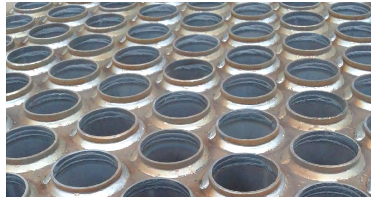
Obr. 130 Svař na nasazených kouřových trubkách
