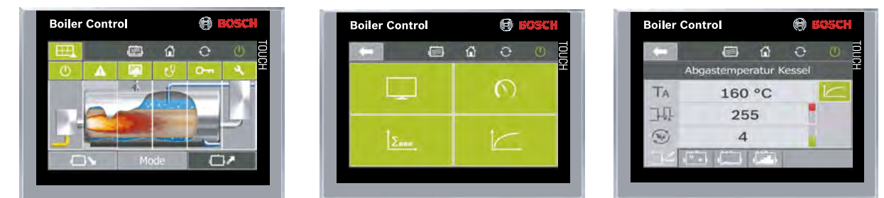
Obr. 83 Příklady pro řízení uživatele na kotlovém řízení BCO
