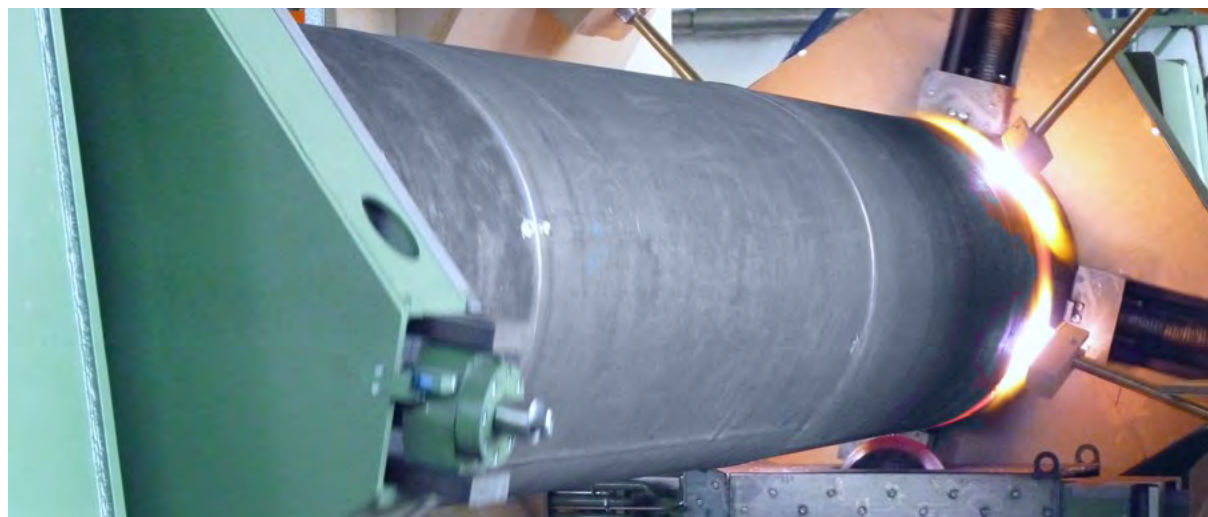
Obr. 132 Plně automatické zařízení vlastní konstrukce na vlnovcové plamence
