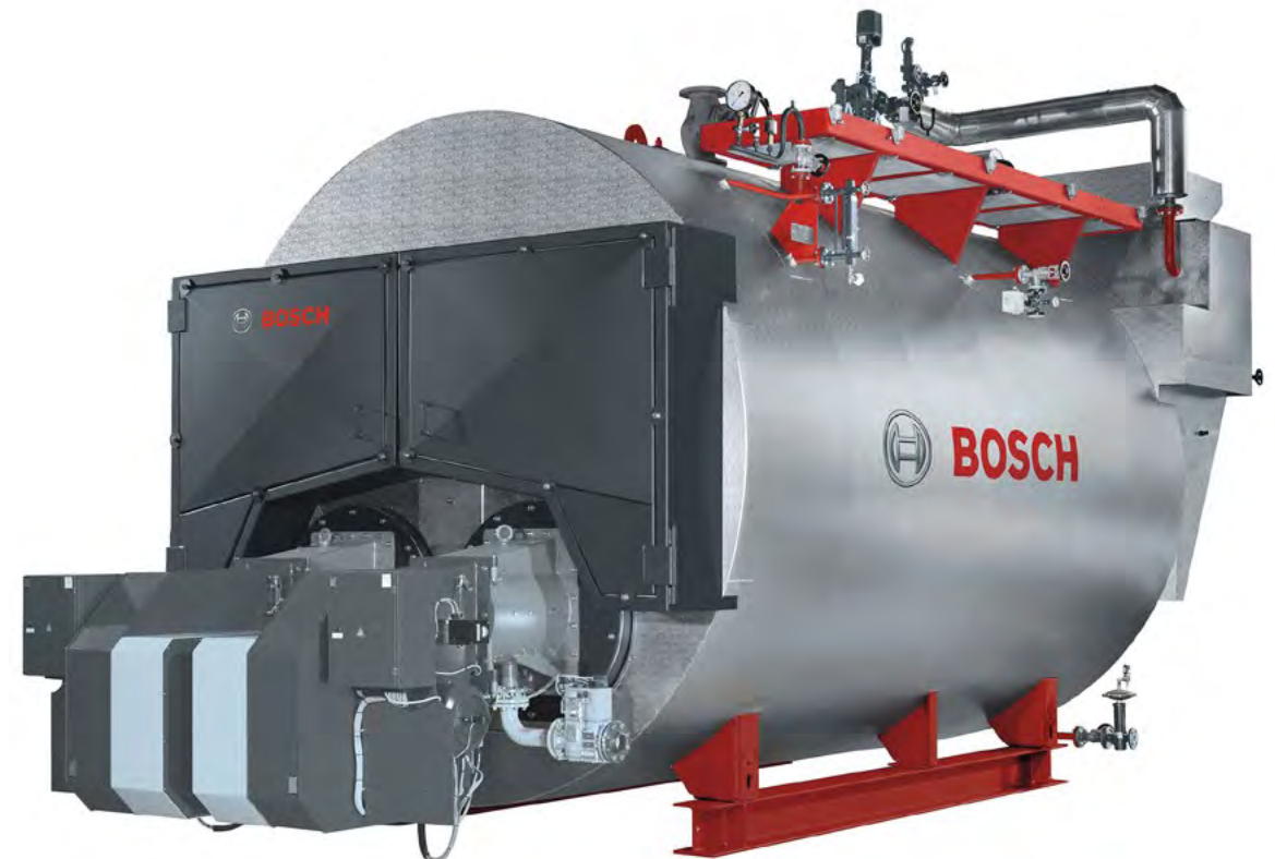
Obr. 41 3 tahový žárotrubný kotel (kotel s velkým vodním prostorem) v dvouplamencovém designu
