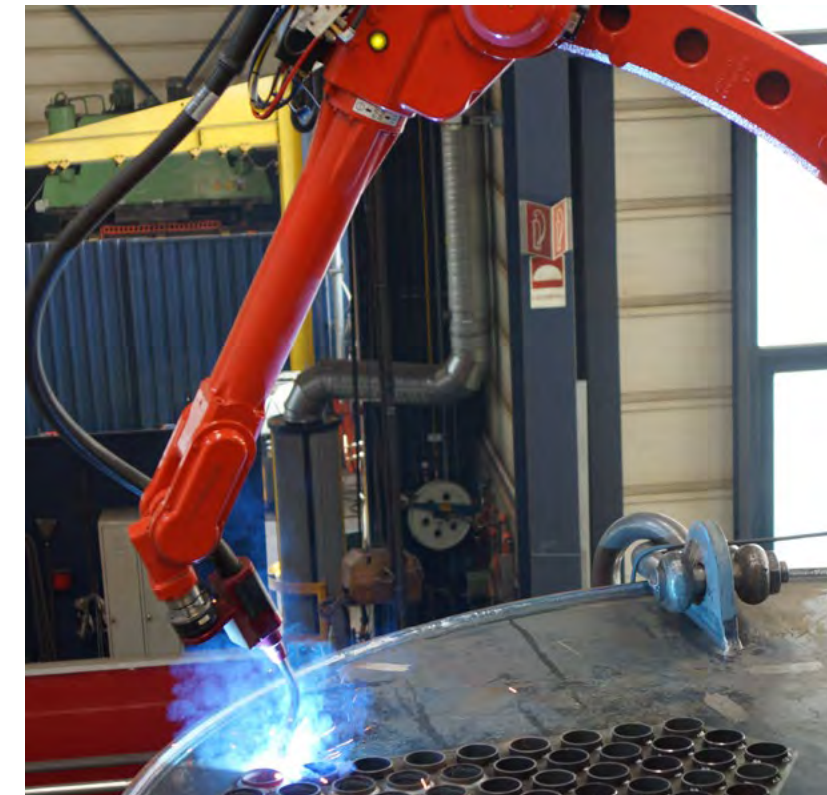
Obr. 133 Mobilní svařovací robot ve výrobě průmyslových kotlů Bosch
