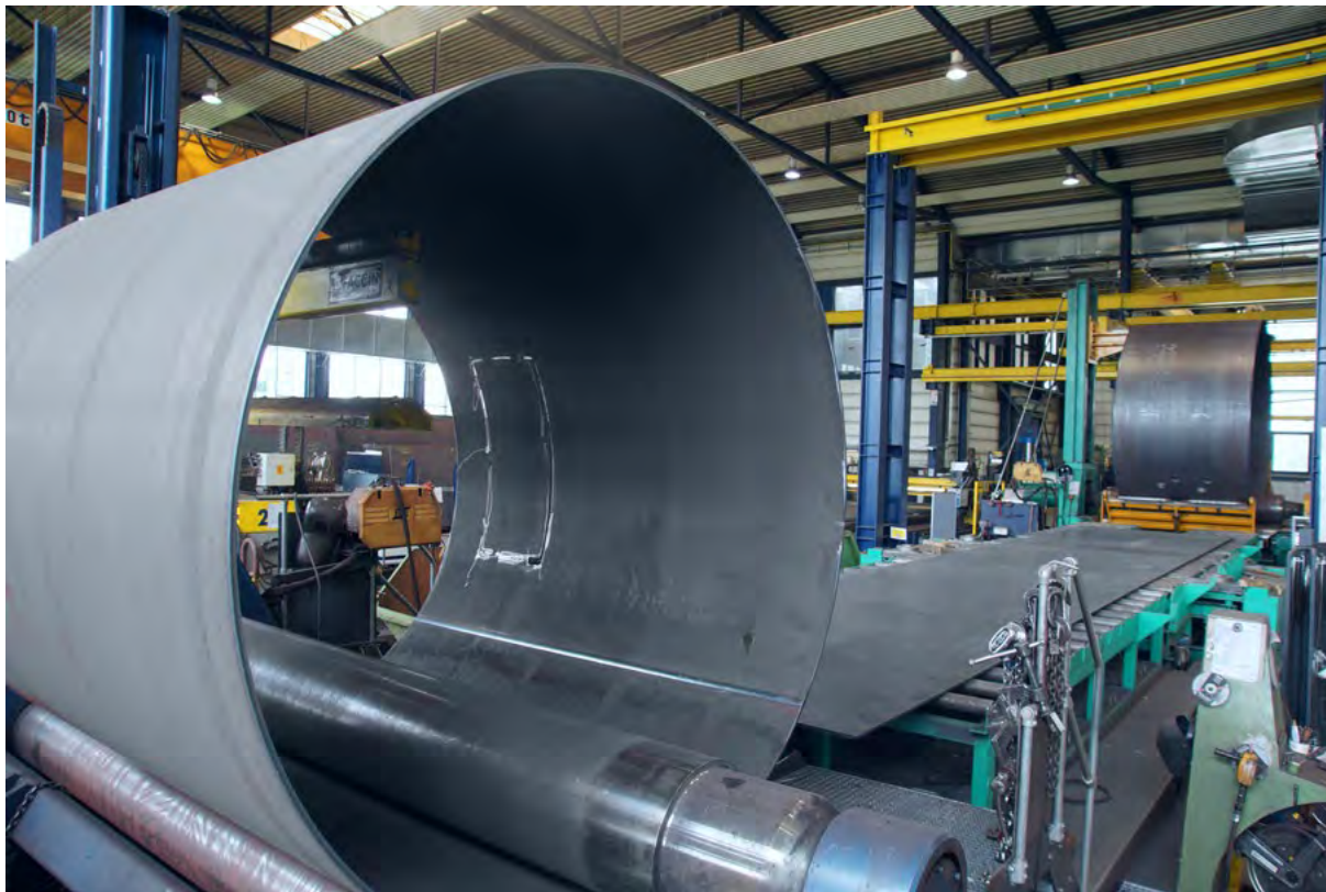
Obr. 134 Možné ohýbání plechů až do šíře 3,5 m
