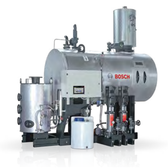
Obr. 97 Zobrazení modulu úpravy vody skládajícího se z nádrže napájecí vody s kaskádovým odplyňovákem, modulů napájecích čerpadel, expandéru, dávkovacích zásobníků a příslušného rozvaděče
